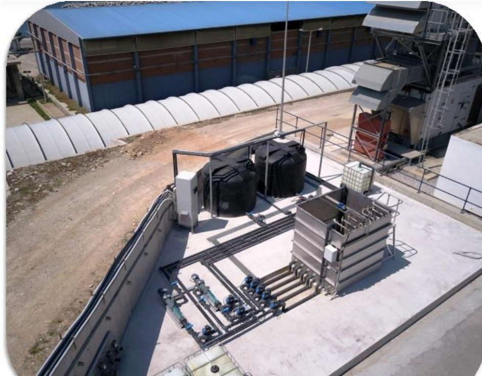
Εικόνα 11 Εγκατάσταση πιλοτικού αντιδραστήρα SBR στην Ψυτάλεια
