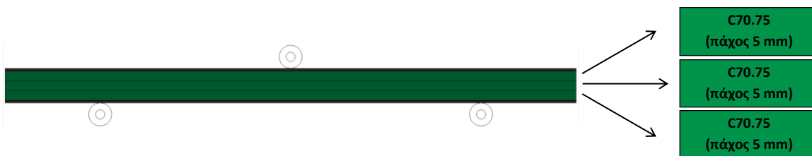
Σχήμα 4.1: Γραφική απεικόνιση της sandwich κατασκευής με ομοιογενή διαμόρφωση πυρήνα [ΜΕΣΑΙΑ/ΜΕΣΑΙΑ/ΜΕΣΑΙΑ] ([C70.75/C70.75/C70.75]).
