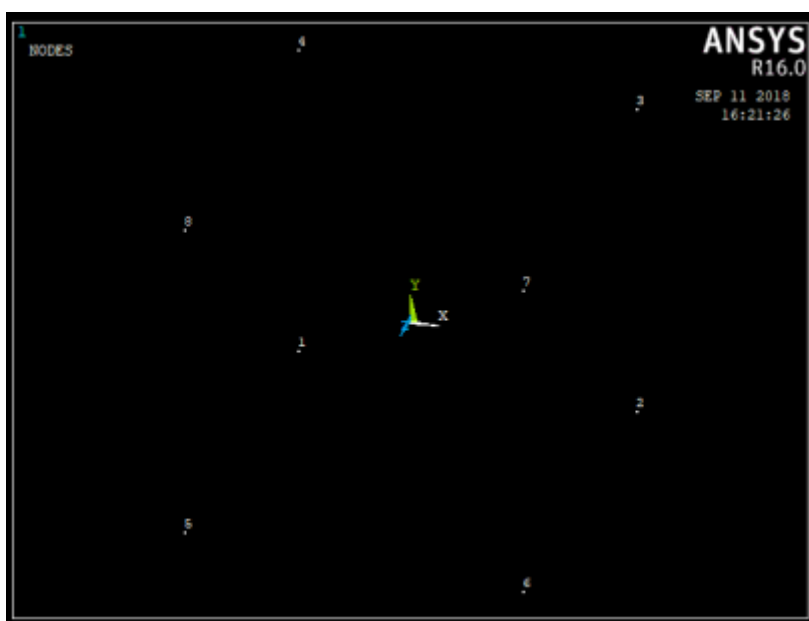
Σχήμα 32: Στιγμιότυπο οθόνης του ANSYS APDL, στο οποίο φαίνονται οι απαραίτητοι κόμβοι για τη δημιουργία του εξαεδρικού στοιχείου.
