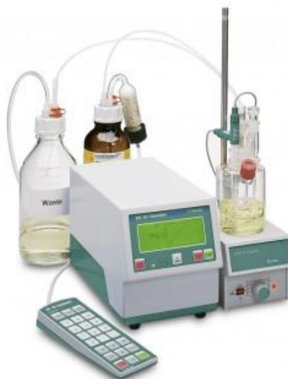
Εικόνα 3. Κουλομετρική συσκευή 831 Titrino της Metrohm
