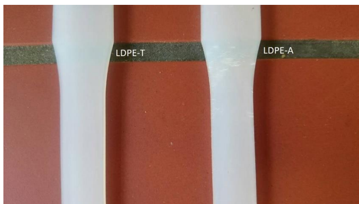
Σχήμα 5.7: LDPE-T και LDPE-A μετά από 60 ημέρες στους 100°C. Είναι εμφανείς οι ρωγμές στην επιφάνεια του δείγματος του LDPE-A.
