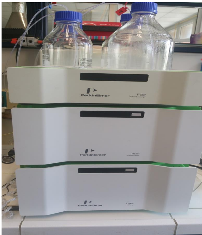
Σχήμα 11: Χρωματογραφικό σύστημα HPLC (Perkin Elmer), όπου φαίνονται τα τμήματα του διαχειριστή διαλύτη (solvent manager), του ανιχνευτή Flexar UV-Vis (UV-Vis detector) και της αντλίας Flexar (LC Pump).
