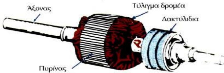
Εικόνα 1.6 Διάταξη δρομέα με δακτυλίου
