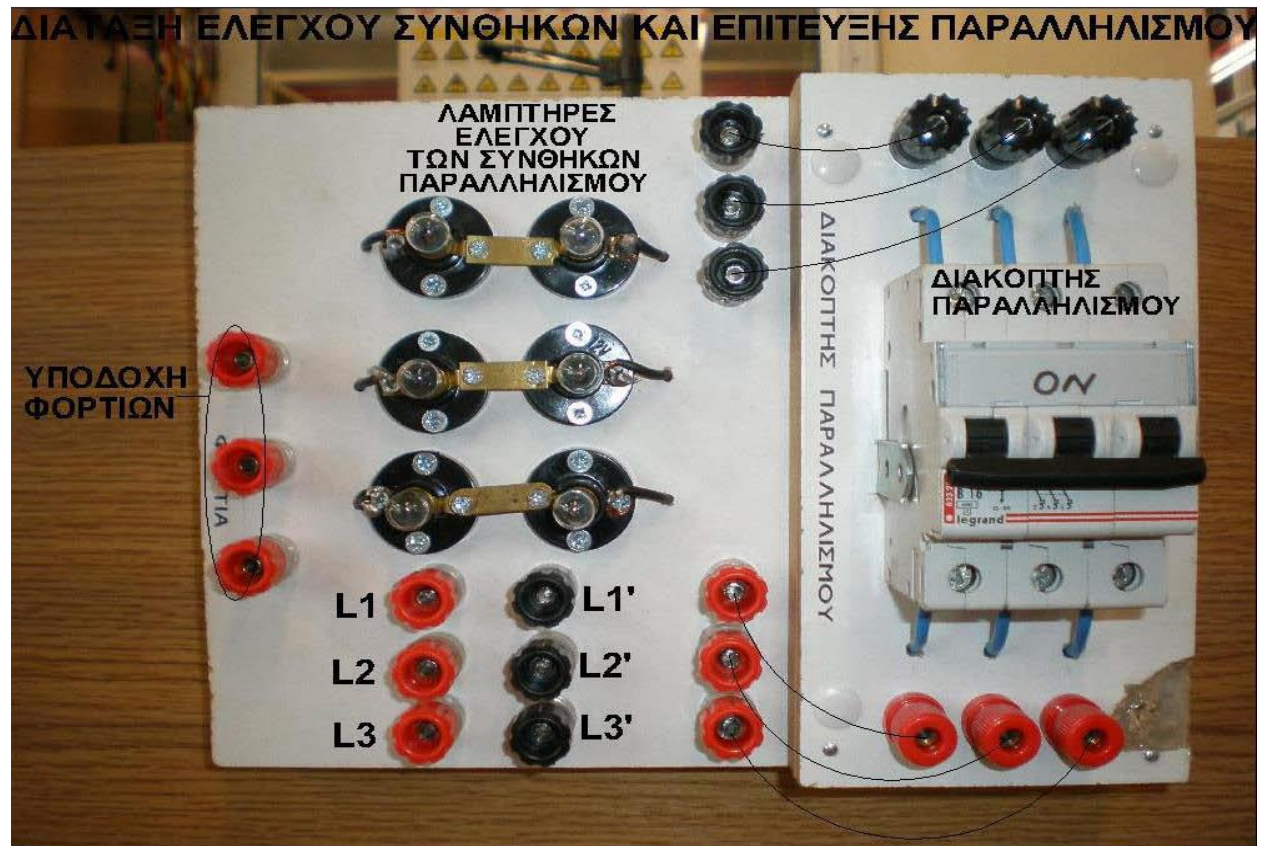
Σχήμα 13. Αυτοσχέδια διάταξη ελέγχου συνθηκών και υλοποίησης του παραλληλισμού
