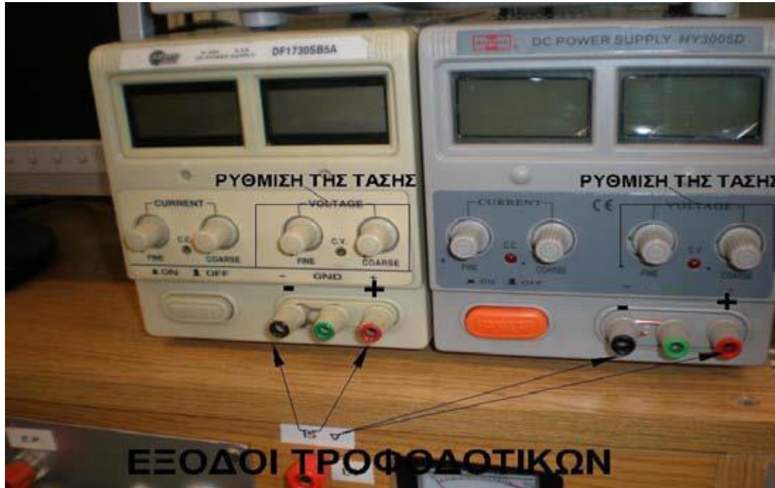
Σχήμα 10. Τροφοδοτικά D.C 0-30 V, 0-5 A
