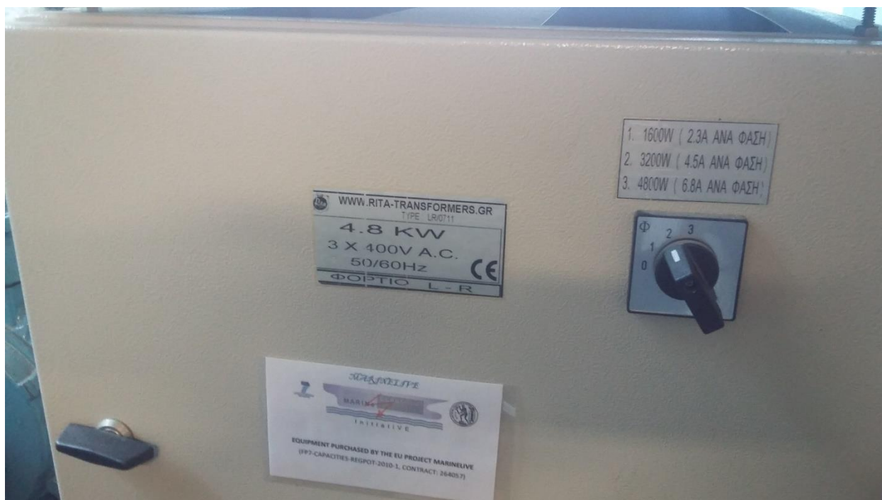
Εικόνα 9α. Οι τρεις διαφορετικές κλίμακες ισχύς του R-L φορτίου
