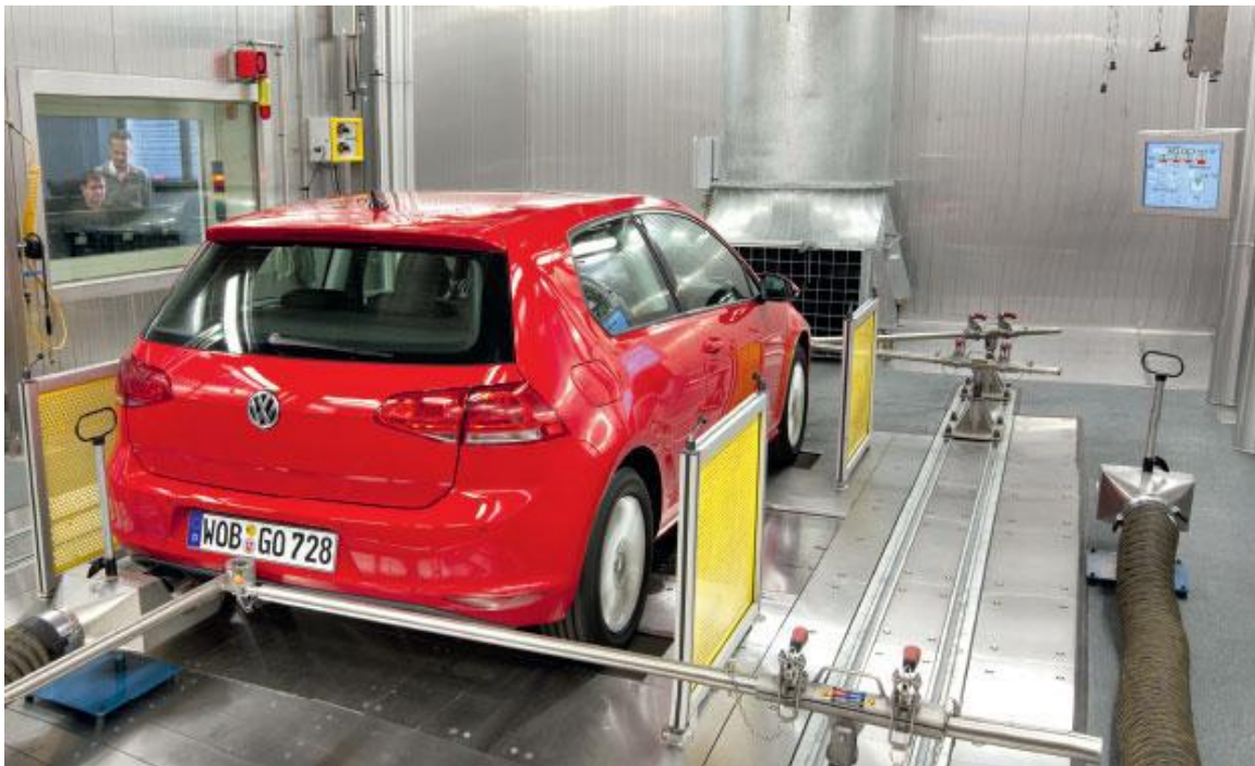
Σχήμα 3.2: Επιβατικό όχημα σε εγκατάσταση Κύκλου Δοκιμής για έλεγχο εκπομπών.
