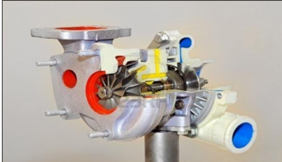
Σχήμα 1.7: Ζεύγος στροβίλο-υπερπληρωτή (γαλάζιο τμήμα: συμπιεστής, κόκκινο τμήμα: στρόβιλος, κίτρινο τμήμα: λίπανση της ατράκτου).
