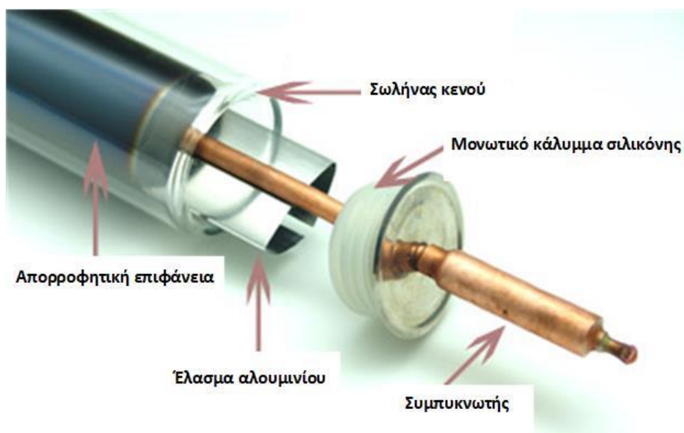
Εικ. 1.8 Σωλήνας κενού με heat-pipe [26]
