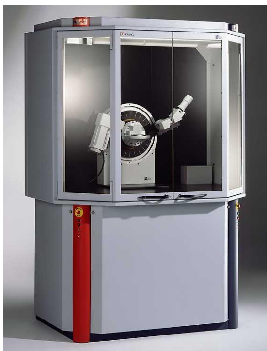
Εικόνα 25: Περιθλασίμετρο ακτίνων X τύπου D8 FOCUS της Bruker. [39]
