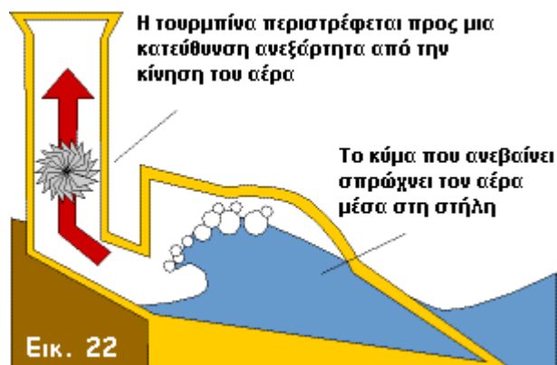
Εικόνα 1.8: Τρόπος εκμετάλλευσης ενέργειας κυμάτων
