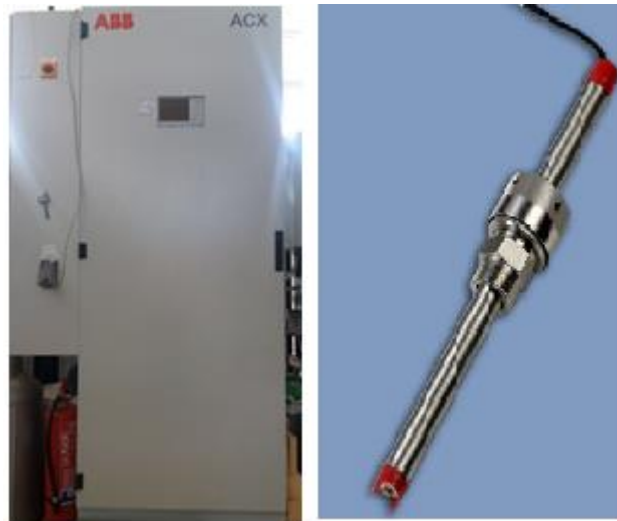
Σχήμα 4.25: Ο αναλυτής καυσαερίων ABB ACX (αριστερά) και το ακροφύσιό του (δεξιά)
