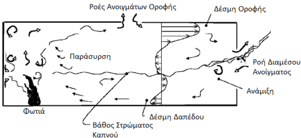
Σχήμα 1.6: Τυπικό ροϊκό πεδίο φωτιάς σε πυροδιαμέρισμα
