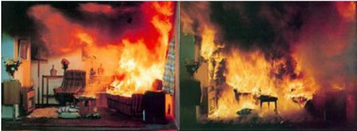
Σχήμα 1.1: Χαρακτηριστικές φωτογραφίες της περιόδου προ της καθολικής ανάφλεξης (αριστερά) και μετά την καθολική ανάφλεξη (δεξιά) σε διαμέρισμα στο οποίο εκδηλώνεται φωτιά.
