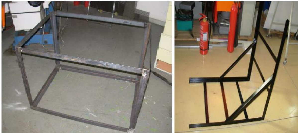
Σχήμα 4.1: Ο βασικός σκελετός (αριστερά) και το κάλυμμα του σκελετού (δεξιά)
