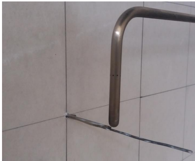
Σχήμα 4.23: Ο σωλήνας Pitot-Static
