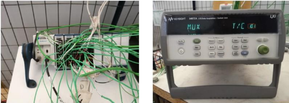
Σχήμα 4.28: Φωτογραφίες των συστημάτων συλλογής δεδομένων NI cDAQ 9172 (αριστερά) και Agilent 34972A (δεξιά).
