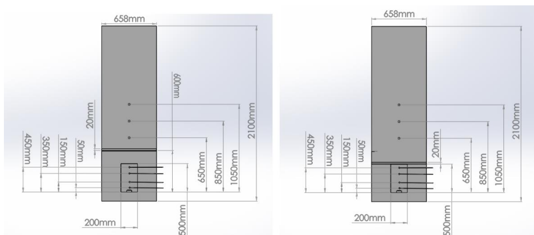
Σχήμα 4.7: Πρόσοψη διαμερίσματος με εξώστη βάθους 200mm σε ύψος Z=600 mm (αριστερά) σε ύψος Z=500 mm (δεξιά)
