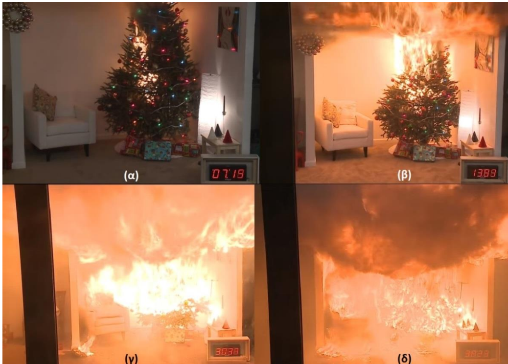
Σχήμα 1.4: Απεικόνιση των διαδοχικών σταδίων φωτιάς σε διαμέρισμα: (α) Ανάφλεξη, (β) Ανάπτυξη, (γ) Καθολική Ανάφλεξη, (δ) Πλήρως Αναπτυγμένη Φωτιά
