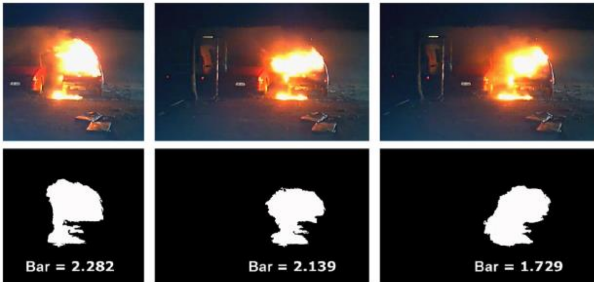
Σχήμα 5.11: Τραχύτητα του εμβαδού των ορίων για διαδοχικές περιοχές φλόγας (Celik et al., 2016).
