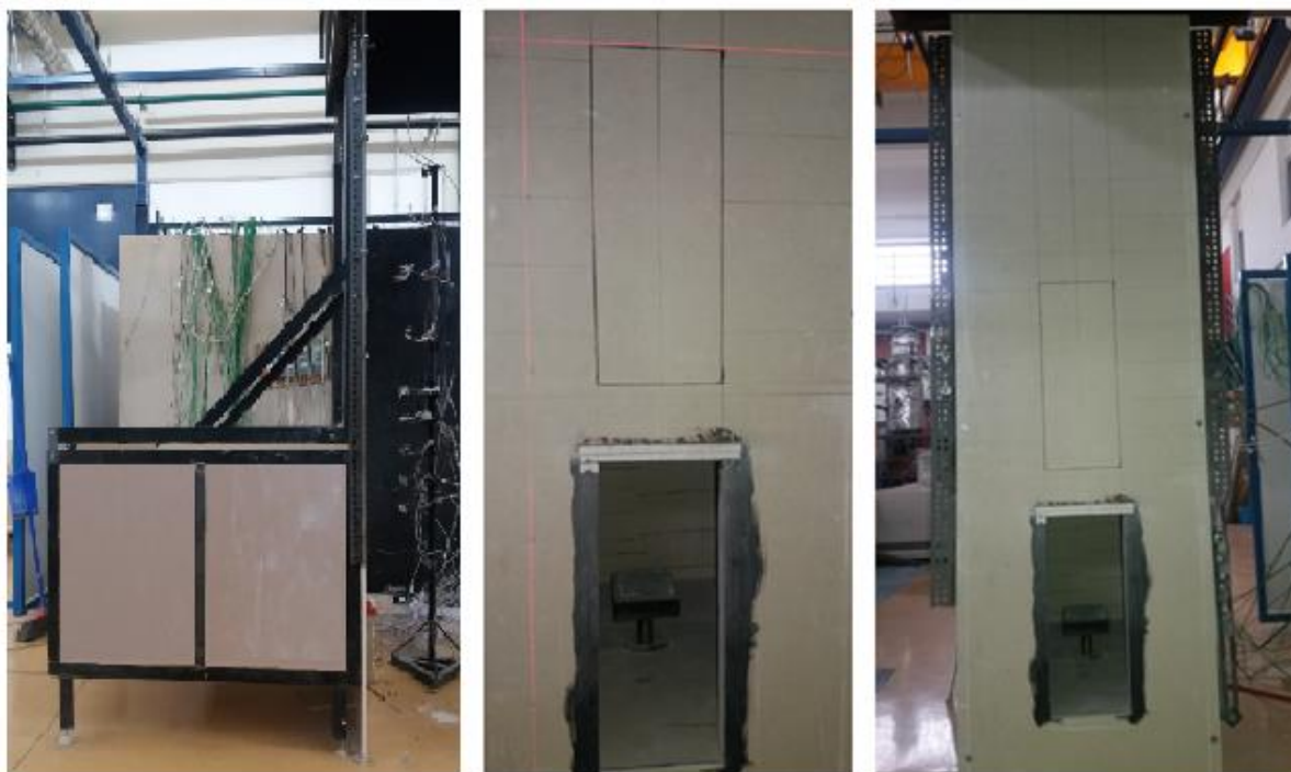
Σχήμα 4.5: Πλάγια όψη της κατασκευής (αριστερά), χάραξη πλέγματος και πλαισίου της πόρτας του άνω ορόφου με τη χρήση laser (κέντρο) και εμπρόσθια όψη της κατασκευής (δεξιά)
