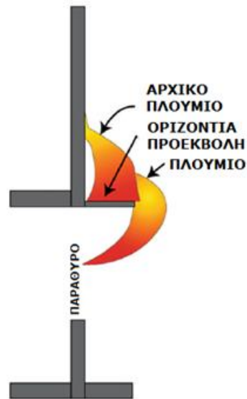
Σχήμα 1.13: Επίδραση οριζόντιας προεκβολής στο πλούμιο ΦΕΑ
