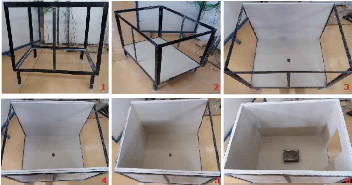
Σχήμα 4.3: Τα βήματα κατασκευής του υπό κλίμακα δωματίου
