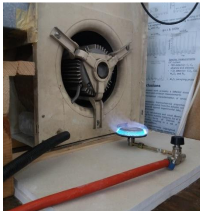
Σχήμα 5.2 Καυστήρας με Ανεμιστήρα
