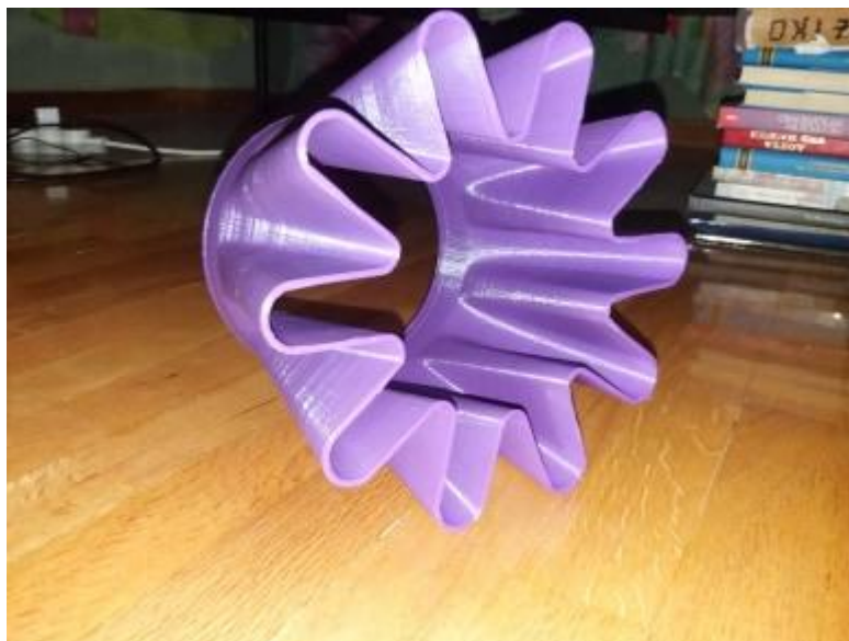
Σχήμα 5.15 Λοβωτό ακροφύσιο κατασκευασμένο με την μέθοδο της τρισδιάστατης εκτύπωσης
