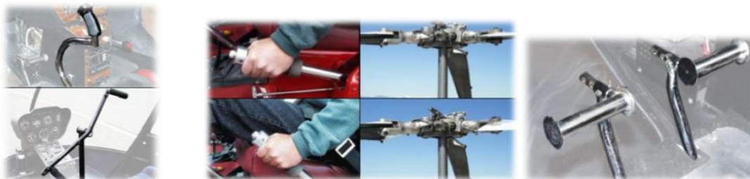
Σχήμα 1.3 : Βασικά μέτρα χειρισμού ελικοπτέρου Cyclic-pitch lever (αριστερά), Collective-pitch lever (μέση) Ποδωστήρια ουραίου στροφείου (δεξιά)
