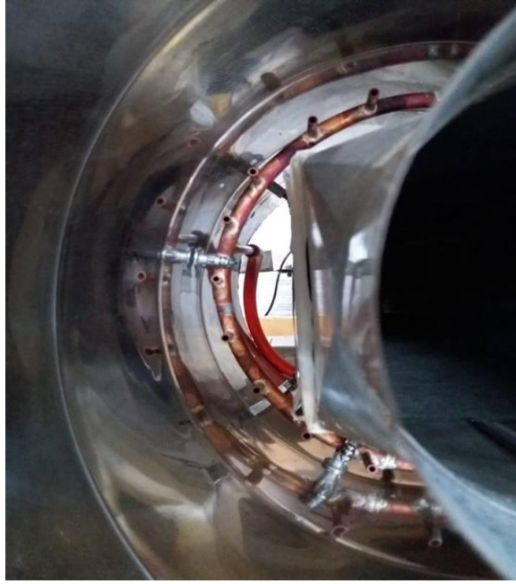
Σχήμα 5.9 Στεφάνι συγκράτησης περιφερειακών εκτοξευτήρων ψυχρού αέρα
