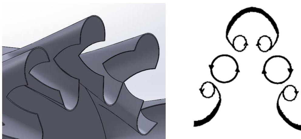
Σχήμα 3.6 : Λοβοί με εγκοπές (αριστερά) και στροβιλισμοί που δημιουργούνται σε αυτούς (δεξιά)
