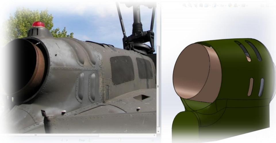
Σχήμα 4.21 : Σύνθεση όλων των συνιστωσών (assembly) με κάλυμμα χωρίς επικάλυψη οπών (δεξιά) και αντιπαραβολή με πραγματική εικόνα (αριστερά)
