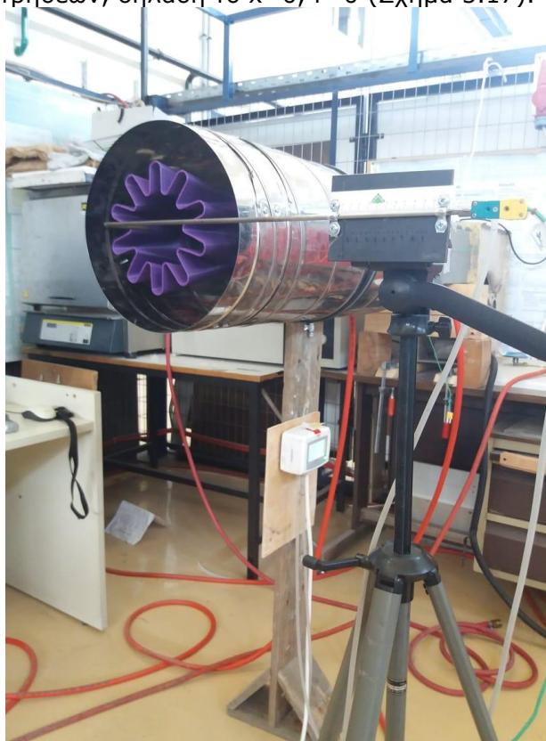
Σχήμα 5.17 Έναυση πειραματικής διαδικασίας με λοβωτό ακροφύσιο
