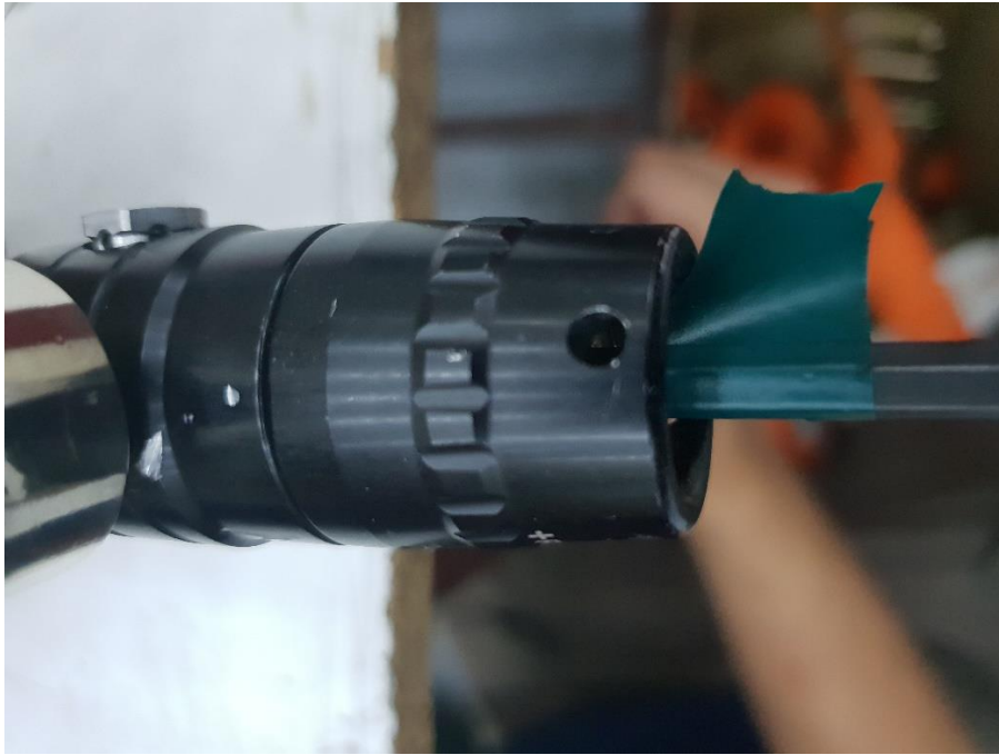
Εικόνα 8.1.3: Διαδικασία ρύθμισης πίεσης εξόδου από το δεύτερο ρυθμιστή πίεσης με χρήση κλειδιού τύπου Allen
