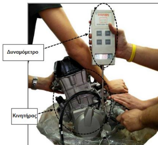
Εικόνα 3.1.1: Μέτρηση απαιτούμενης δύναμης αλλαγής ταχύτητας
