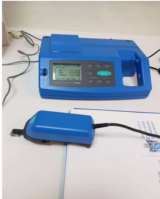
ΣΧΗΜΑ 6.13: ΚΑΤΑΛΛΗΛΗ ΤΟΠΟΘΕΤΗΣΗ ΑΚΙΔΑΣ (ΑΝΙΧΝΕΥΤΗ) ΓΙΑ ΜΕΤΡΗΣΗ ΤΡΑΧΥΤΗΤΑΣ
