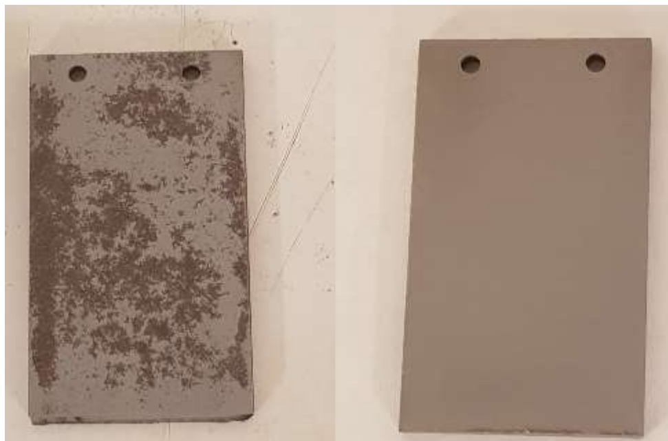
ΣΧΗΜΑ 6.2: ΕΠΙΦΑΝΕΙΑ ΔΟΚΙΜΙΟΥ ΠΡΙΝ (ΑΡΙΣΤΕΡΑ) ΚΑΙ ΜΕΤΑ (ΔΕΞΙΑ) ΤΗΝ ΥΠΟΒΟΛΗ ΤΟΥ ΣΤΗ ΔΙΕΡΓΑΣΙΑ ΤΗΣ ΑΜΜΟΒΟΛΗΣ
