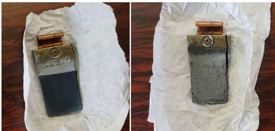
ΣΧΗΜΑ 6.8: ΑΝΟΔΟΣ ΚΑΘΑΡΟΥ ΨΕΥΔΑΡΓΥΡΟΥ ΠΡΙΝ (α) ΚΑΙ ΜΕΤΑ (β) ΤΟΝ ΚΑΘΑΡΙΣΜΟ ΤΗΣ ΣΕ ΠΥΚΝΟ ΔΙΑΛΥΜΑ ΗCl.
