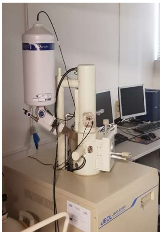
ΕΙΚΟΝΑ 6.11: ΤΟ ΗΛΕΚΤΡΟΝΙΚΟ ΜΙΚΡΟΣΚΟΠΙΟ ΣΑΡΩΣΗΣ (SEM) ΣΤΟ ΟΠΟΙΟ ΜΕΛΕΤΗΘΗΚΑΝ ΤΑ ΔΕΙΓΜΑΤΑ ΤΩΝ ΔΟΚΙΜΙΩΝ ΤΗΣ ΠΑΡΟΥΣΑΣ ΔΙΠΛΩΜΑΤΙΚΗΣ ΕΡΓΑΣΙΑΣ
