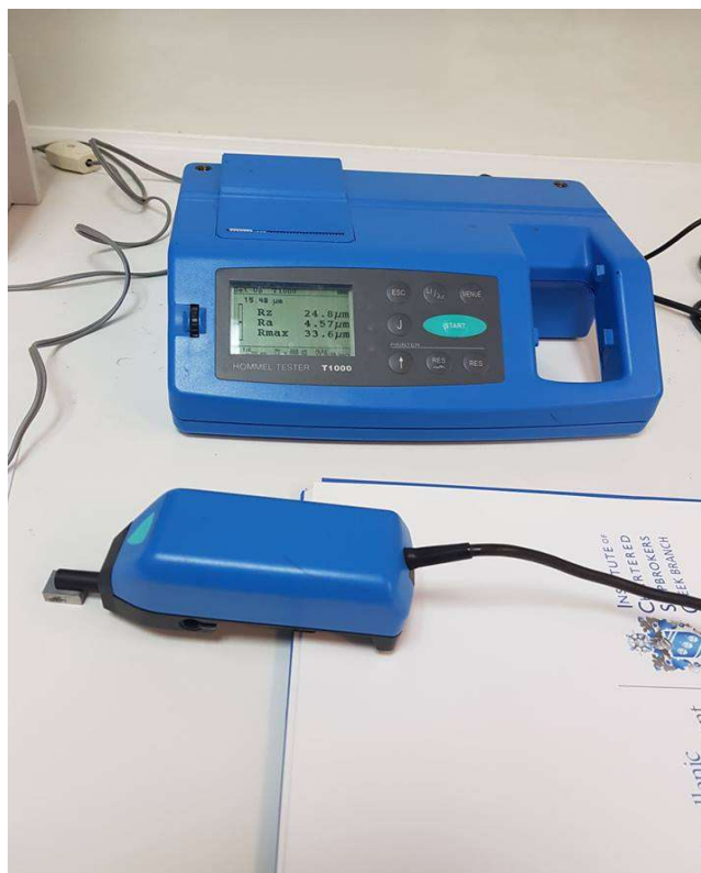
ΕΙΚΟΝΑ 5.4: ΨΗΦΙΑΚΟ ΤΡΑΧΥΜΕΤΡΟ (ΕΡΓΑΣΤΗΡΙΟ ΓΕΝΙΚΗΣ ΧΗΜΕΙΑΣ ΣΧΟΛΗ ΧΗΜ. ΜΗΧ. ΕΜΠ)
