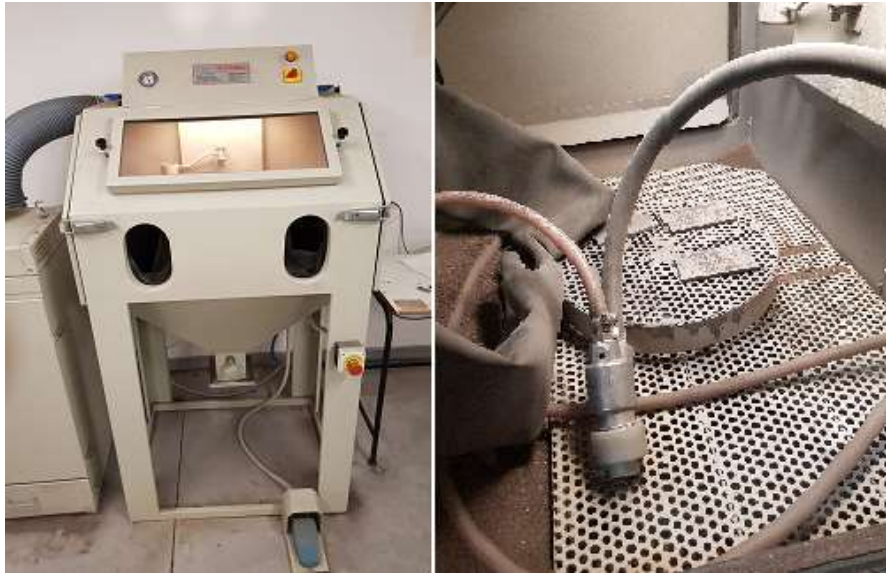
ΣΧΗΜΑ 6.1: ΣΥΣΚΕΥΗ ΑΜΜΟΒΟΛΗΣ ΜΗΧΑΝΟΥΡΓΕΙΟΥ ΣΧΟΛΗΣ ΝΑΥΠΗΓΩΝ ΜΗΧΑΝΟΛΟΓΩΝ ΜΗΧΑΝΙΚΩΝ. ΣΤΗΝ ΑΡΙΣΤΕΡΗ ΦΩΤΟΓΡΑΦΙΑ ΦΑΙΝΕΤΑΙ ΕΞΩΤΕΡΙΚΑ ΚΑΙ ΣΤΗ ΔΕΞΙΑ ΕΣΩΤΕΡΙΚΑ
