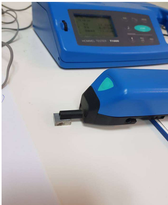
ΣΧΗΜΑ 6.14: ΜΕΤΡΗΣΗ ΤΡΑΧΥΤΗΤΑΣ
