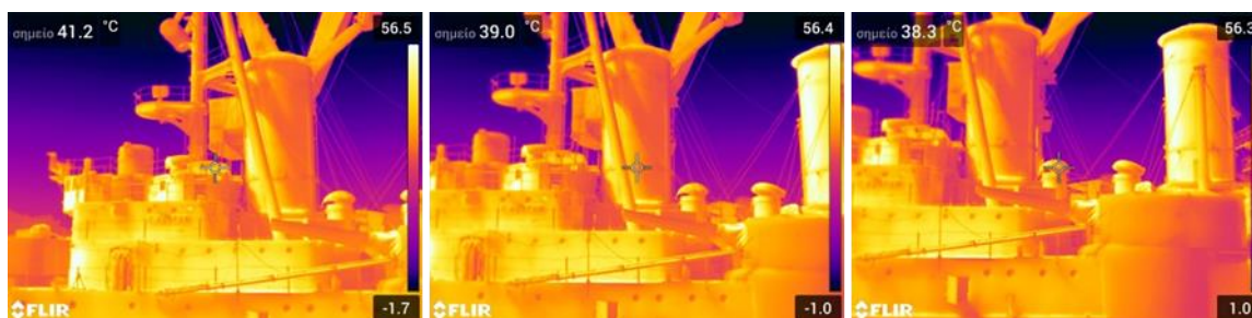
Εικόνα 3.12 - Επάλληλες επικαλυπτόμενες θερμικές εικόνες της υπερκατασκευής του Θ/Κ «Γ. Αβέρωφ»
