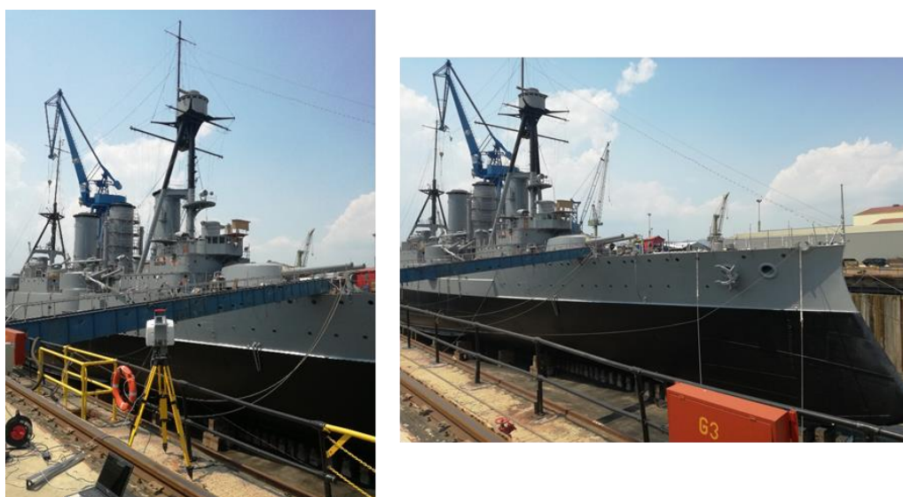
Εικόνα 3.9 - 1η ημέρα εργασιών, Ναυπηγεία Σκαραμαγκά, Ιούνιος 2017 - Αποτύπωση της δεξιάς πρωραίας πλευράς του Θ/Κ «Γ. Αβέρωφ»
