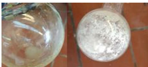
Εικόνα 18: Ένωση μετά από απομάκρυνση ουρίας (αριστερά) και η παραλαβή του εστέρα της κυκλοεξανόλης (δεξιά).
