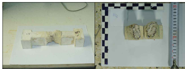
Δοκίμιο και επιφάνειες αστοχίας ΚΓ6
