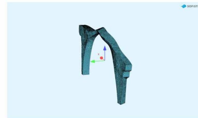
16 η Ιδιομορφή T=0.063 Διεύθυνση Z-Z (Κατακόρυφος Σεισμός) , ποσοστό συμμετοχής 16.0%
