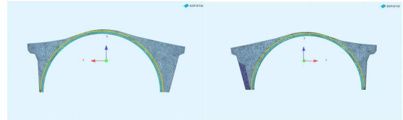
Εικόνα 8.5 Όψεις φορέα από κατάντη και ανάντη με χρωματισμό ανάλογα με το υλικό
