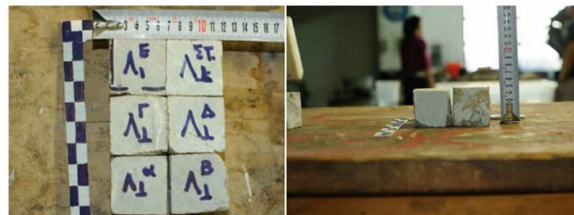
Εικόνα 5.2 Διαμόρφωση κυβικών δοκιμίων ακμής 50 mm
