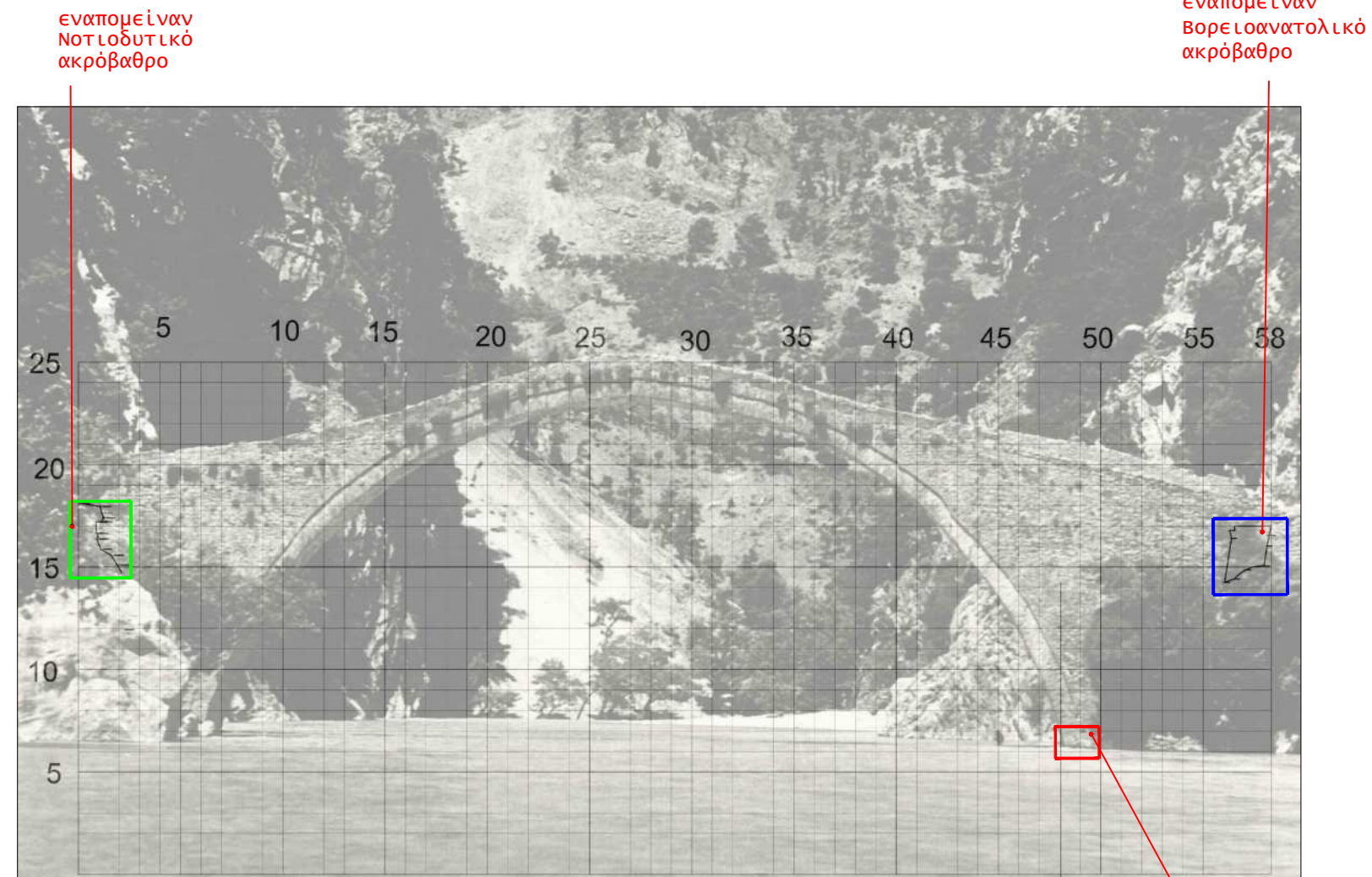
Εικόνα 3.10 Υπέρθυση σημερινών αποτυπώσεων στην κλιμακωμένη φωτογραφία της όψης από κατάντη
