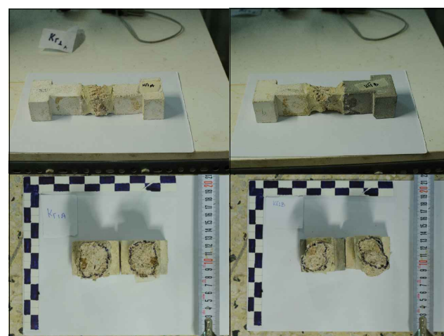
Δοκίμια και επιφάνειες αστοχίας ΚΓ1 A/B
