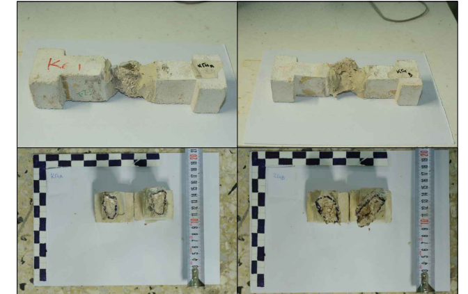
Δοκίμια και επιφάνειες αστοχίας ΚΓ4 Α/Β
