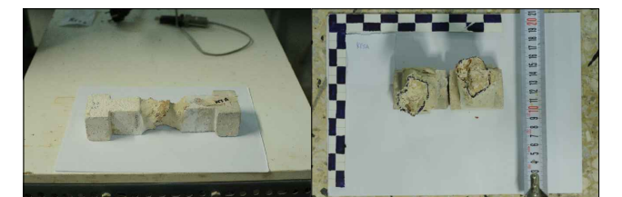
Δοκίμιο και επιφάνειες αστοχίας ΚΓ5 Α
