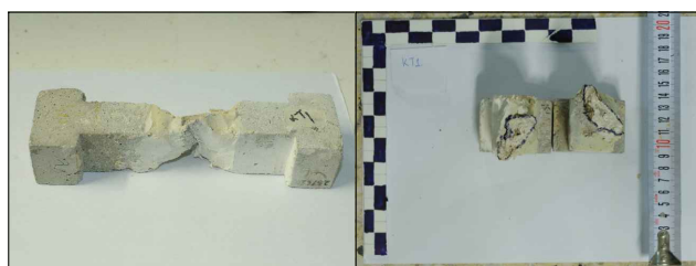
Δοκίμιο και επιφάνειες αστοχίας ΚΤ1
