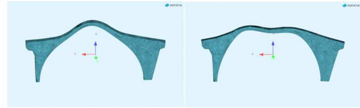
5 η Ιδιομορφή T=0.157 , ποσοστό συμμ. 11.5% 7 η Ιδιομορφή T=0.141 , ποσοστό συμμ. 44.8% Διεύθυνση Z-Z (Κατακόρυφος Σεισμός)
