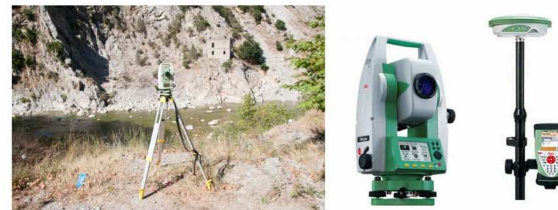
Εικόνα 2.6 Τοπογραφικές μετρήσεις με χρήση του TS02 FLEX LINE PLUS LEICA Εξάρτηση δικτύου LEICA VIVA GS08 PLUS NETROVER
