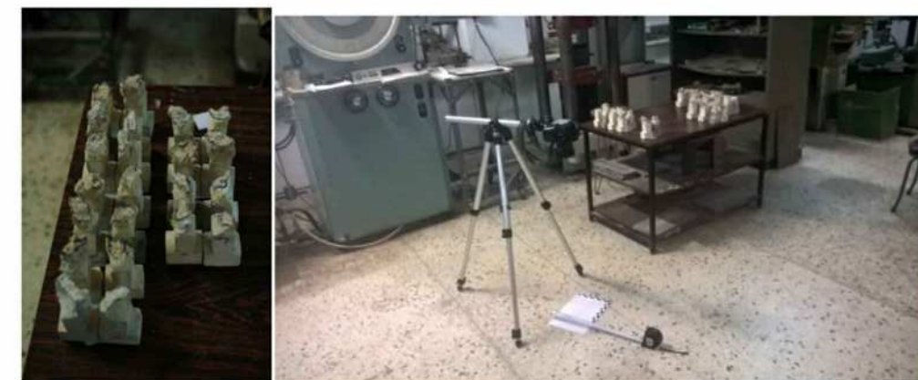
Εικόνα 5.10 – Επιφάνειες αστοχίας δειγμάτων και διάταξη μέτρησης εμβαδού.
