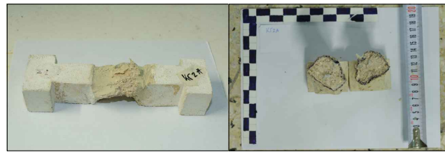
Δοκίμια και επιφάνειες αστοχίας ΚΓ2 Α
