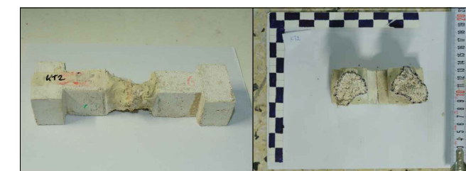
Δοκίμιο και επιφάνειες αστοχίας ΚΤ2
