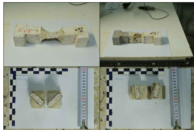
Δοκίμια και επιφάνειες αστοχίας ΚΓΛ1-2Α/Β
