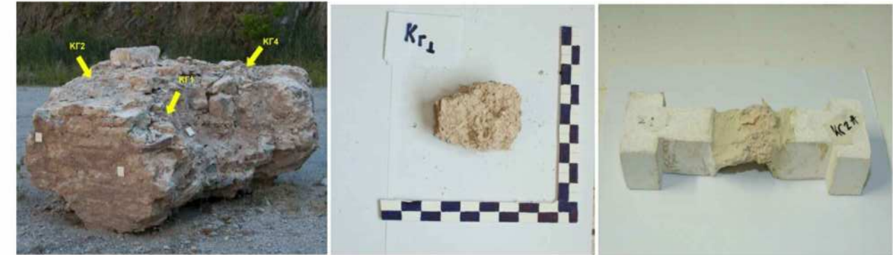
Εικόνα 5.8 – Λήψη δείγματος, άποψη στο εργαστήριο και διαμόρφωση δοκιμίου
