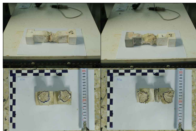
Δοκίμια και επιφάνειες αστοχίας ΚΓ3 Α/Β
