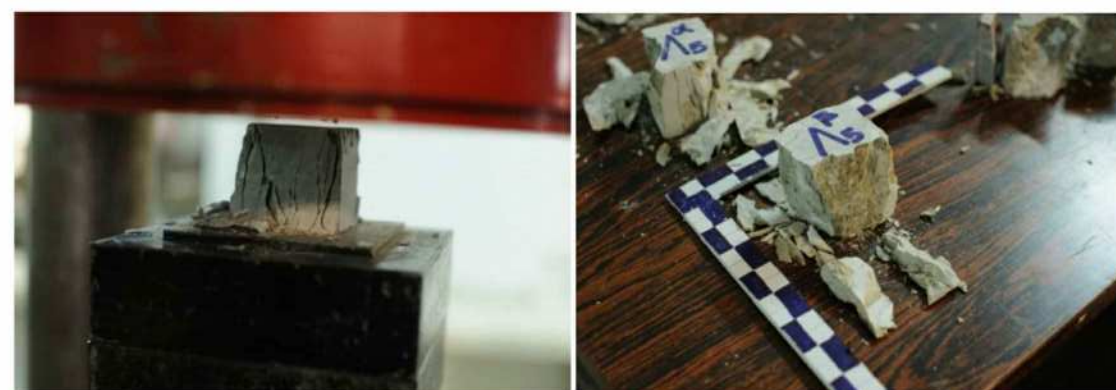
Εικόνα 5.3 Επιβολή θλιπτικής δύναμης και τυπική θραύση δοκιμίου
