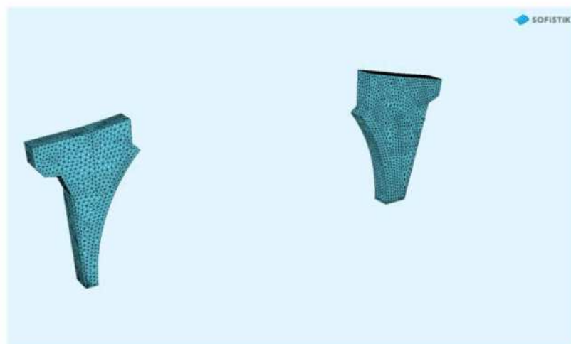
Εικόνα 8.10 Στο τέλος της 1 ης φάσης υπολογισμός τάσεων για χρήση στην ανάλυση του φορέα κατά το τελικό στάδιο κατασκευής . Θεώρηση μηδενικών παραμορφώσεων στην αρχή του 2 ου σταδίου.
