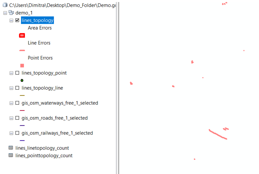
Εικόνα 6. 39 Εξαγωγή τοπολογικών σφαλμάτων στο δίκτυο
