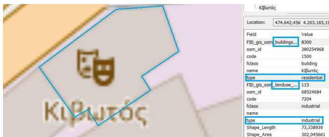
Εικόνα 1. 3 Το πολύγωνο αυτό έχει χαρακτηριστεί ως “residential”(οικιστική περιοχή) από το θεματικό επίπεδο των κτηρίων, ενώ από το θεματικό επίπεδο των χρήσεων γης ως “industrial”(βιομηχανική περιοχή)
