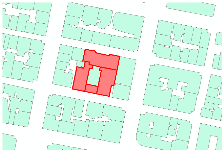
Εικόνα 6. 29 Building_topology_poly παράδειγμα τοπολογικού σφάλματος
