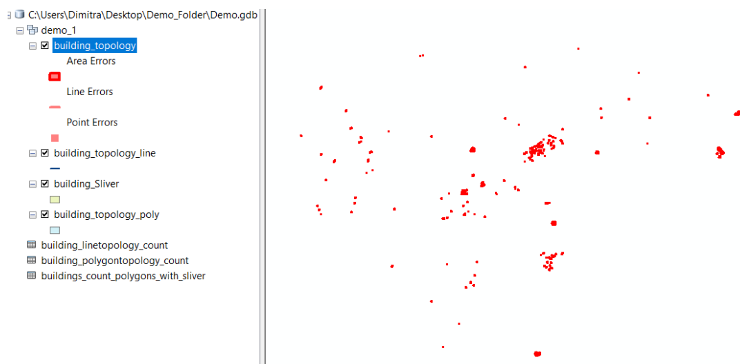
Εικόνα 6. 27 Εξαγωγή τοπολογικών σφαλμάτων στα κτήρια
