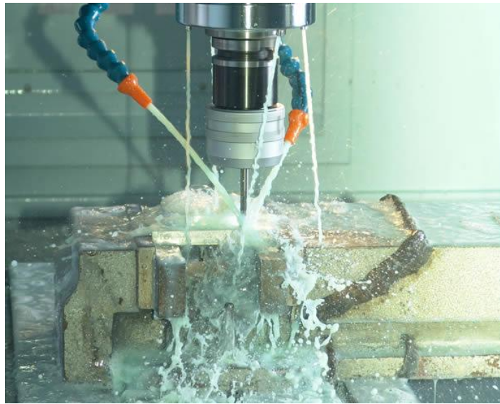
Εικόνα 4-16: Ψύξη συστήματος κοπτικού-τεμαχίου αποβλίττου μέσω της μεθόδου της πλημμύρας (Flooded cooling)
