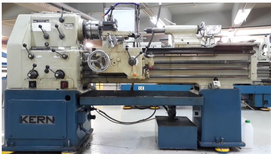
Εικόνα 6-7: Συμβατικός τόρνος Fritz Kern K.G. D18L
