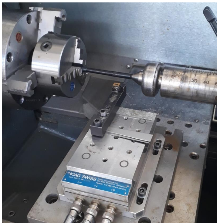
Εικόνα 7-4: Πειραματική διάταξη για κατεργασία του δοκιμίου και μέτρηση των παραγόμενων δυνάμεων κατά την τórνευση
