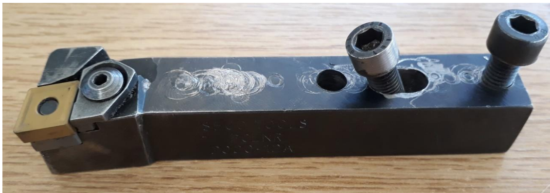
Εικόνα 6-10: Μανέλλα με τοποθετημένο πλακίδιο κοπής
