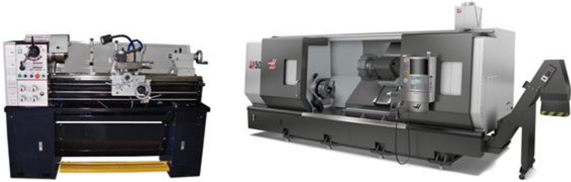
Εικόνα 4-17: Αριστερά παρουσιάζεται ένας συμβατικός τόνος, ενώ δεξιά ένα σύγχρονο CNC κέντρο κατεργασίας τόννευσης
