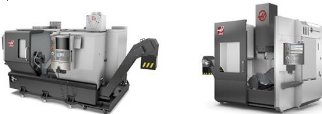
Εικόνα 4-1: Κέντρο κατεργασίας τόννευσης (αριστερά) και κέντρο κατεργασίας φρεζαρίσματος (δεξιά)
