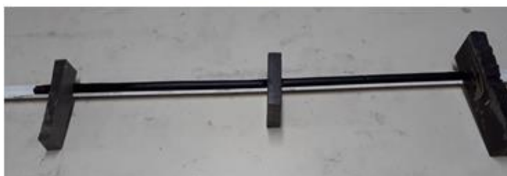
Εικόνα 7-2: Διαδικασία εκβολής σύνθετου υλικού (πάνω) και σύνθετο υλικό που έχει αφεθεί να έρθει σε θερμοκρασία δωματίου (κάτω)
