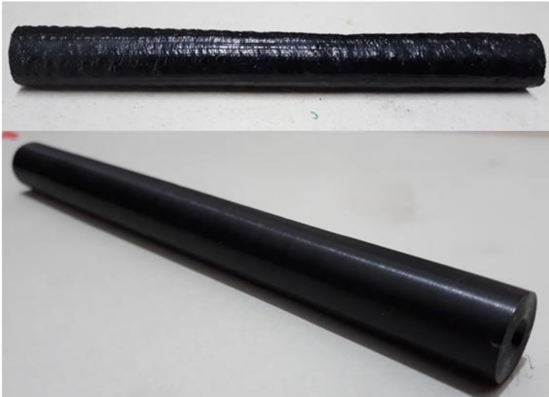
Εικόνα 7-3: Στο πάνω μέρος παρουσιάζεται ένα δοκίμιο σύνθετου υλικού πριν τον καθαρισμό, ενώ στο κάτω μέρος εμφανίζεται μετά τον καθαρισμό και τη δημιουργία οπής στο ένα άκρο του
