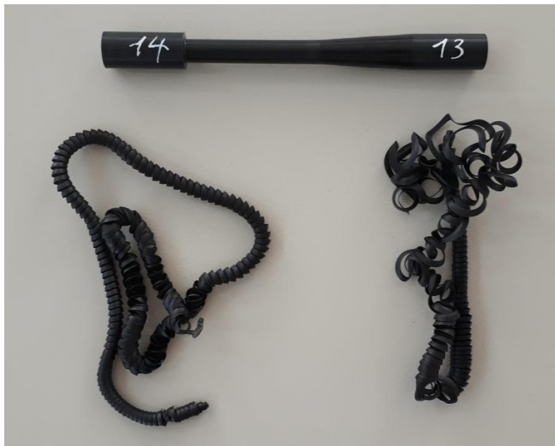
Εικόνα 7-5: Κατεργασμένο δοκίμιο, με το πείραμα 13 στο δεξί άκρο και το πείραμα 14 στο αριστερό και με τα αντίστοιχα παραχθέντα απόβλητα
