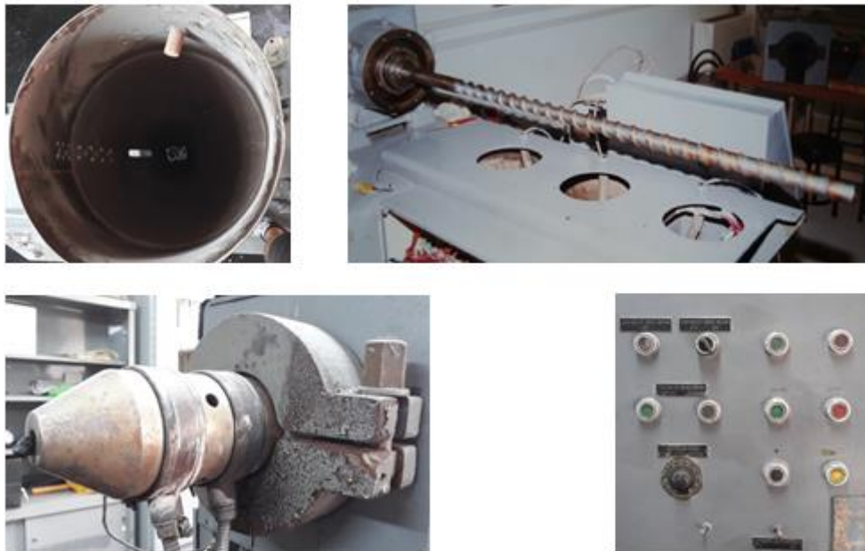
Εικόνα 6-5: α) Χοάνη τροφοδοσίας εκβολέα (πάνω αριστερά), β) Κοχλίας εκβολέα (πάνω δεξιά), γ) Μήτρα εκβολής προφίλ (κάτω αριστερά), δ) Πίνακας ελέγχου εκβολέα (κάτω δεξιά)
