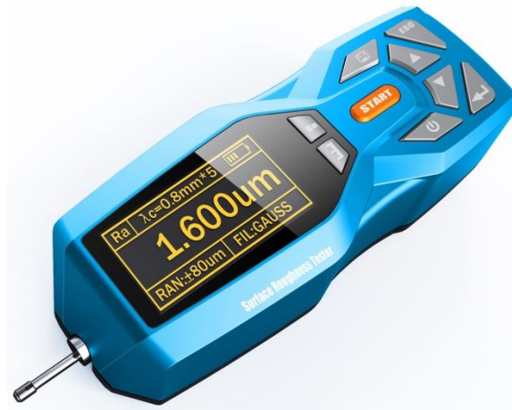
Εικόνα 5-8: Ηλεκτρομηχανικό τραχύμετρο στυλίσκου
