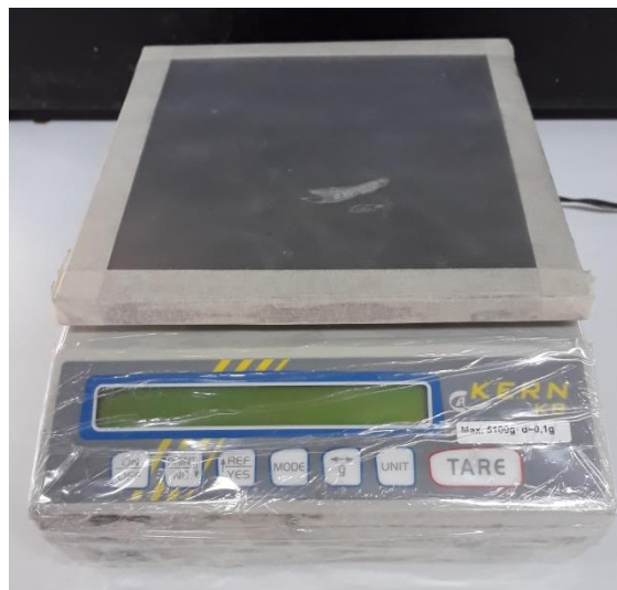
Εικόνα 6-3: Ζυγός ακριβείας KERN KB 5000-1
