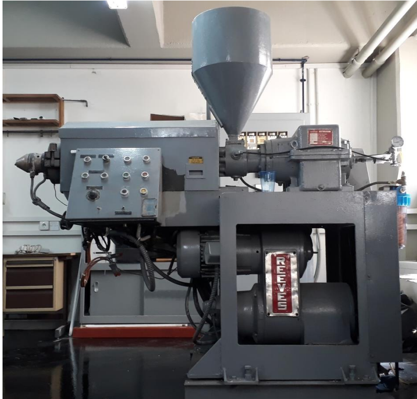
Εικόνα 6-4: Εκβολέας παραγωγής προφίλ του εργαστηρίου Κατεργασιών των υλικών του Εθνικού Μετσόβιου Πολυτεχνείου
