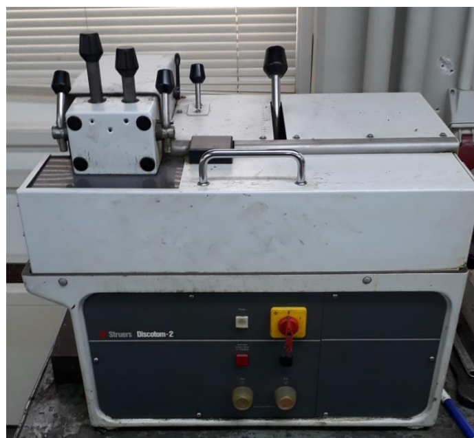
Εικόνα 6-6: Δισκοτόμος Struers Discotom-2
