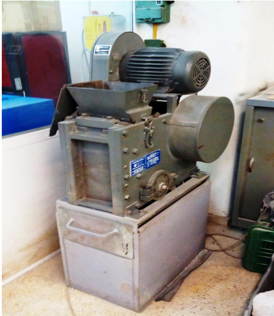
Εικόνα 20: Θραυστήρας σιαγόνων Εργαστηρίου Εμπλουτισμού Μετ/των Ε.Μ. Πολυτεχνείου.
