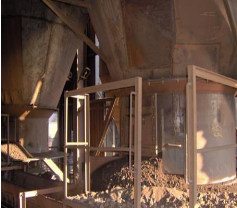
Εικόνα 10: Σιλό ανάμιξης πρώτων υλών
