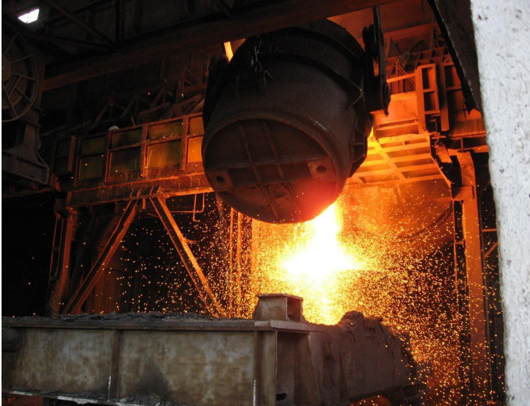
Εικόνα 13: Μεταλλάκτης OBM του εργοστασίου ΛΑΡΚΟ
