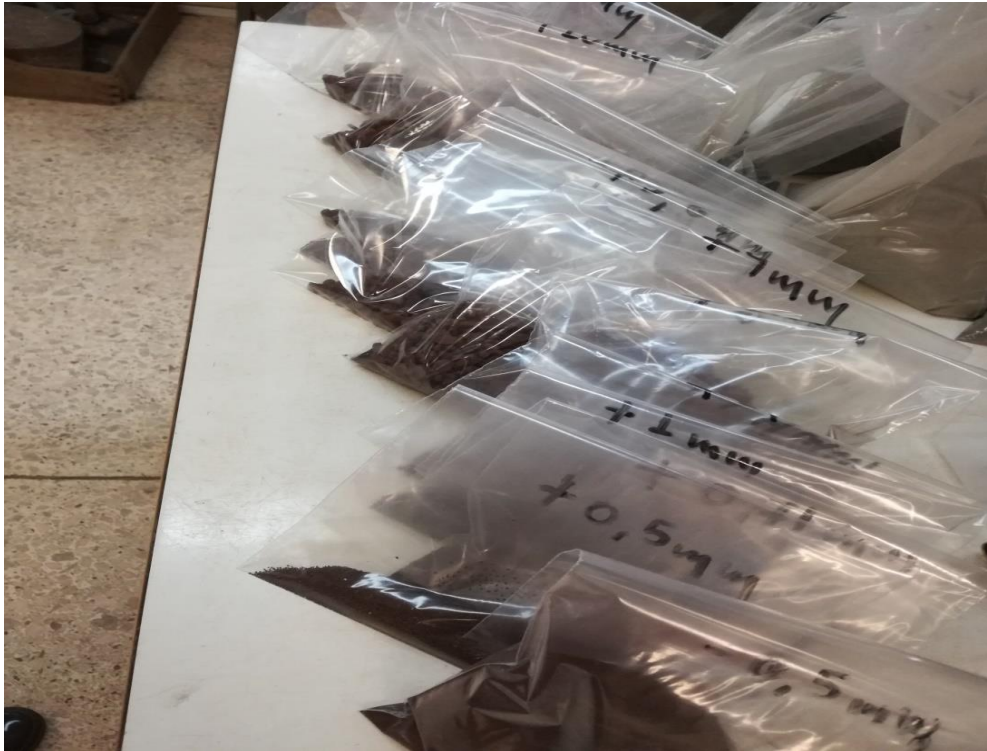
Εικόνα 23: Κοκκομετρική ταξινόμηση του δείγματος της ΛΑΡΚΟ
