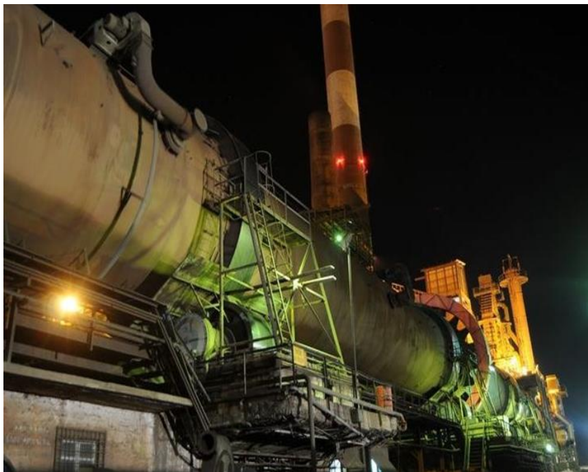
Εικόνα 11: Περιστροφικές κάμινοι του εργοστασίου ΛΑΡΚΟ
