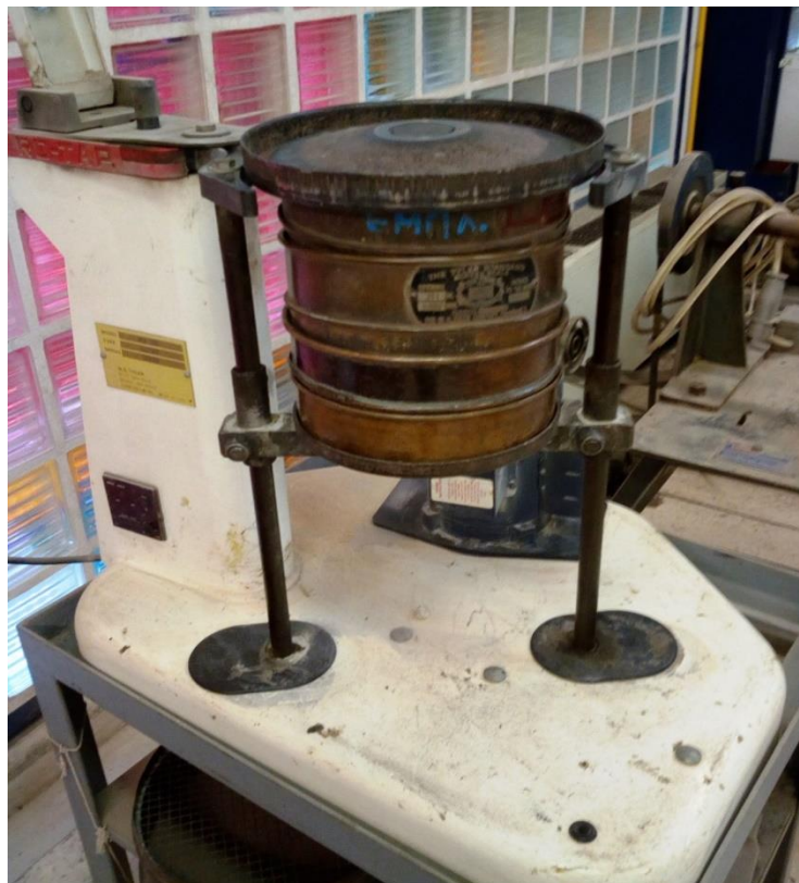
Εικόνα 22: . Διάταξη μηχανικής κοσκίνισης (Ro-tap) Εργαστηρίου Εμπλουτισμού Μετ/των Ε.Μ.Π.
