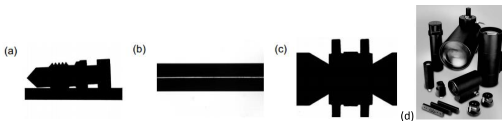
Εικόνα 10.24: (α) έλεγχος σε γυαλιστερό κατεργασμένο τεμάχιο, (β) μέτρηση διαμέτρου σε γυάλινη ράβδο, (γ) έλεγχος πληρότητας κομματιών συσσωρευτή (sinter), (δ) εξαρτήματα τηλεκεντρικού φωτισμού [4]
