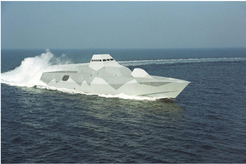
Σχήμα 1.5: Σκάφος stealth του Σουηδικού Ναυτικού με γάστρα από CFRP sandwich
