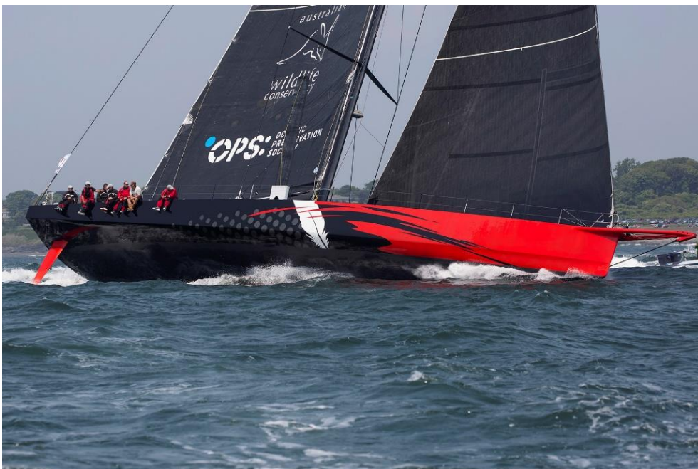
Σχήμα 1.4: Το ιστιοπλοϊκό σκάφος Comanche με κατασκευή γάστρας από προ-εμποτισμένα υφάσματα CFRP ( By Billy Black - Photographer for Sail, CC BY-SA 4.0)
