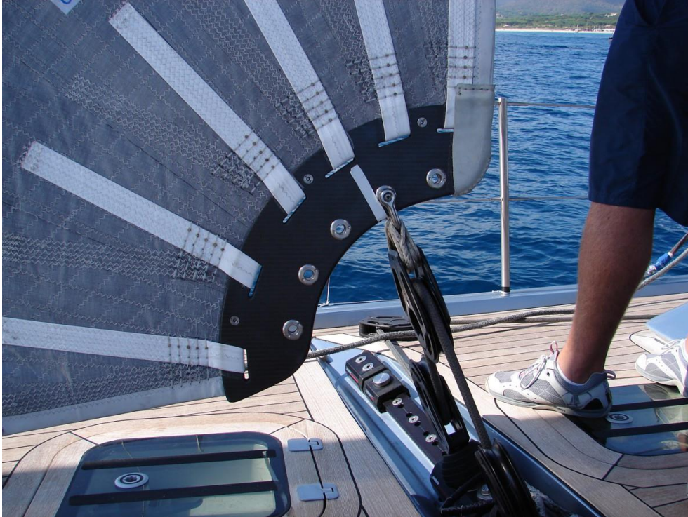
Σχήμα 1.3: Εξάρτημα Clewboard ιστιοπλοϊκού σκάφους της εταιρίας Quick Batten από CFRP
