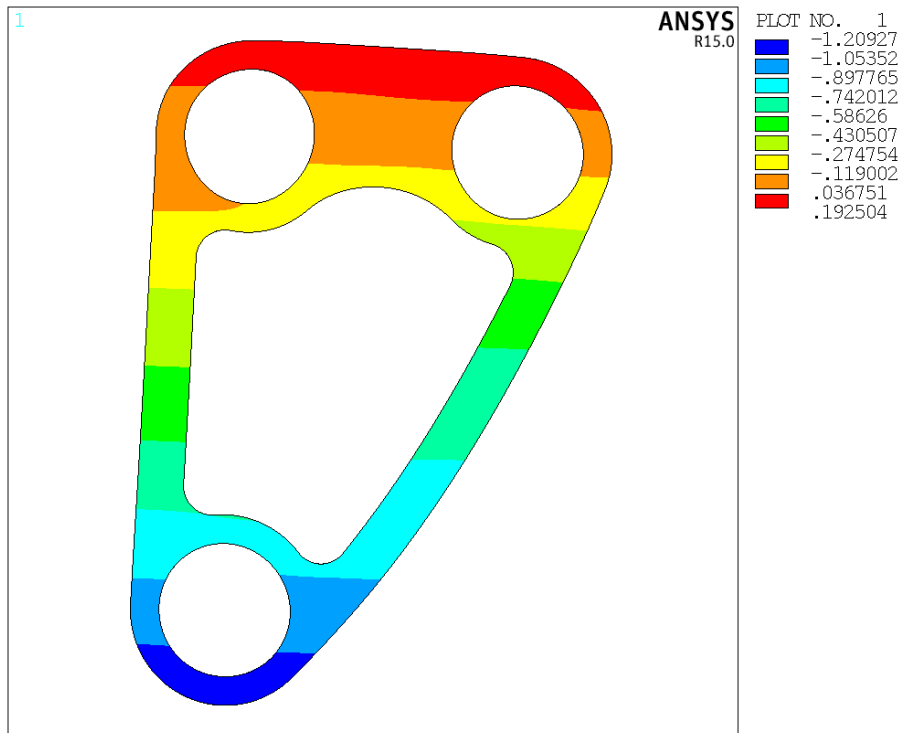
Σχήμα 2.62: Μετατοπίσεις στον άξονα X για τον πολύστρωτο [0/45] s
