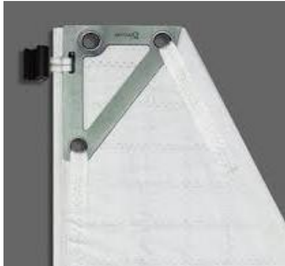
Σχήμα 2.27: Headboard τοποθετημένο σε ιστίο
