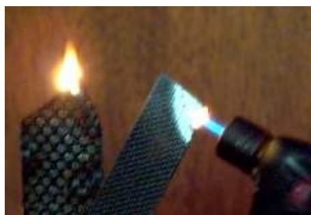
Εικόνα 1.4: Εποξεικό σύνθετο με άνθρακα (αριστερά) αναφλέγεται, ενώ γεωπολυμερικό σύνθετο με άνθρακα (δεξιά) αντέχει ακόμα στους 1200°C.
