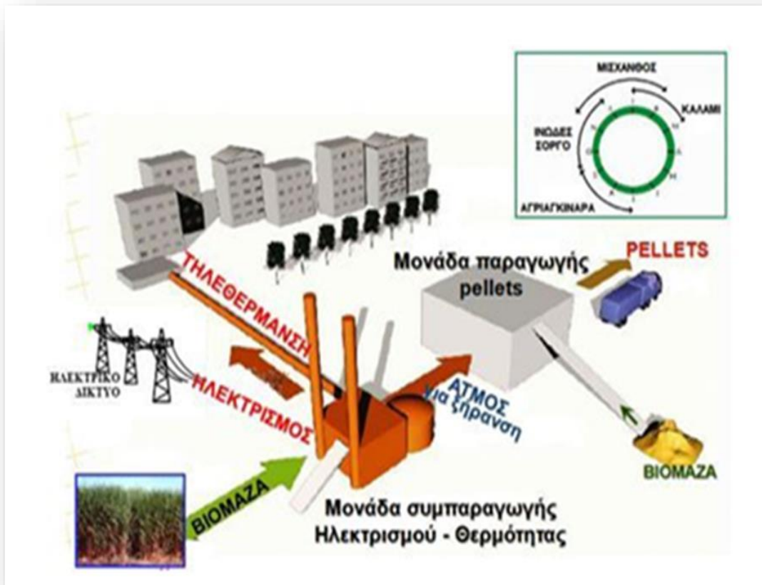
Σχήμα 10. Διαδικασία Συμπαραγωγής Ενέργειας
