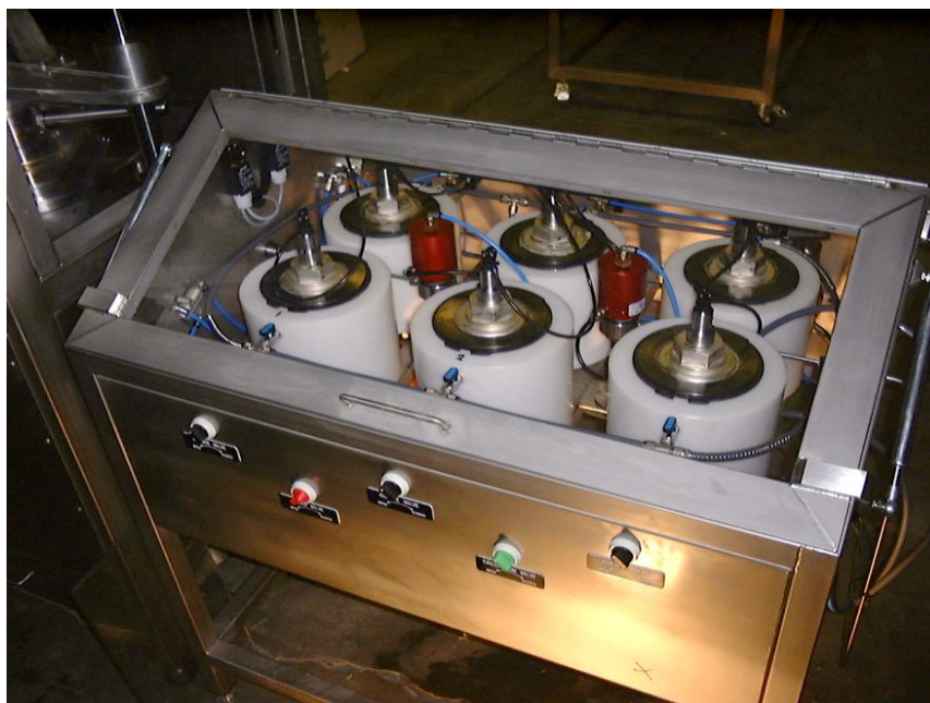
Εικόνα 6.4: Λεπτομέρεια των μικρών θαλάμων ΥΥΠ. Διακρίνονται οι διακόπτες που ελέγχουν τις πνευματικές θάννες για την απομόνωση του κάθε θαλάμου.
