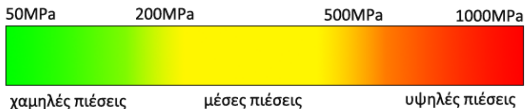
Σχήμα 2.2: Το «φάσμα» της υπερυψηλής πίεσης. Σε όρους υπερυψηλής πίεσης, χαμηλές θεωρούνται συνήθως πιέσεις κάτω από 150MPa, μέσες μεταξύ 200 και 500MPa και υψηλές από 550 μέχρι 1000.
