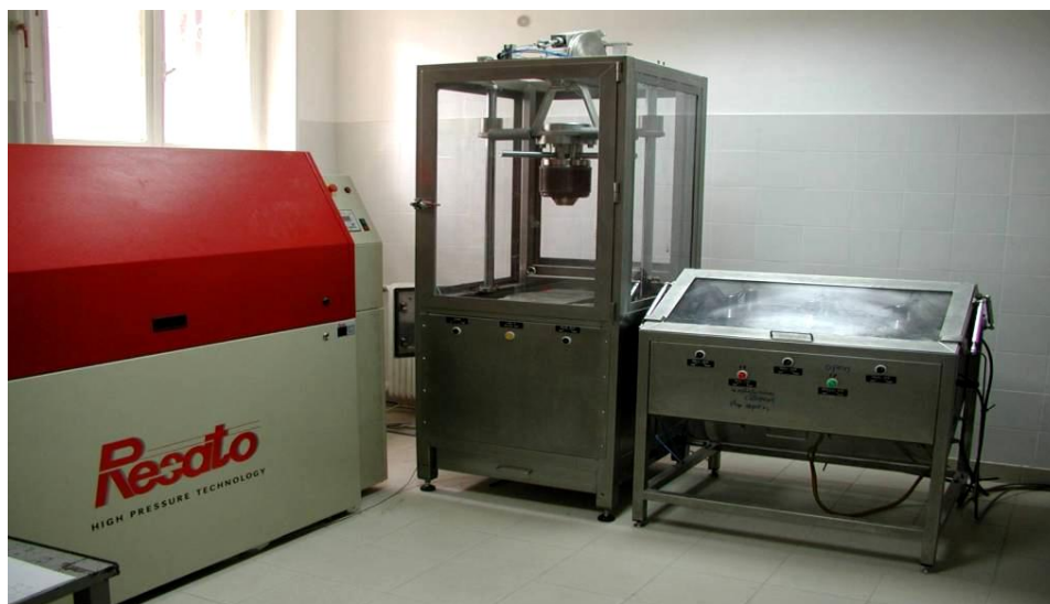
Εικόνα 6.3: Το σύστημα υπερυψηλής υδροστατικής πίεσης που χρησιμοποιήθηκε για τα πειράματα. Αριστερά φαίνεται η μονάδα ΥΥΠ, στο κέντρο ο θάλαμος όγκου 1.5L και δεξιά η συστοιχία των 6 μικρότερων θαλάμων όγκου 42mL.
