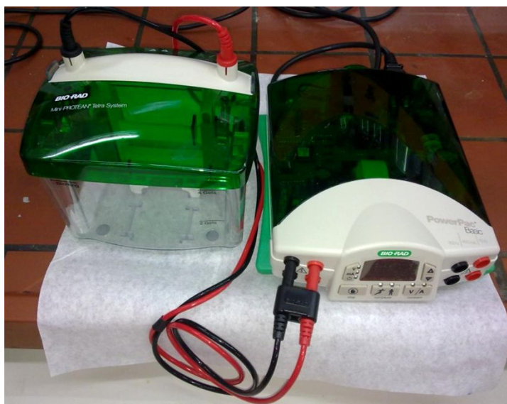
Εικόνα 6.2: πειραματική διάταξη ηλεκτροφόρησης πήγματος ακρυλαμιδίου.
