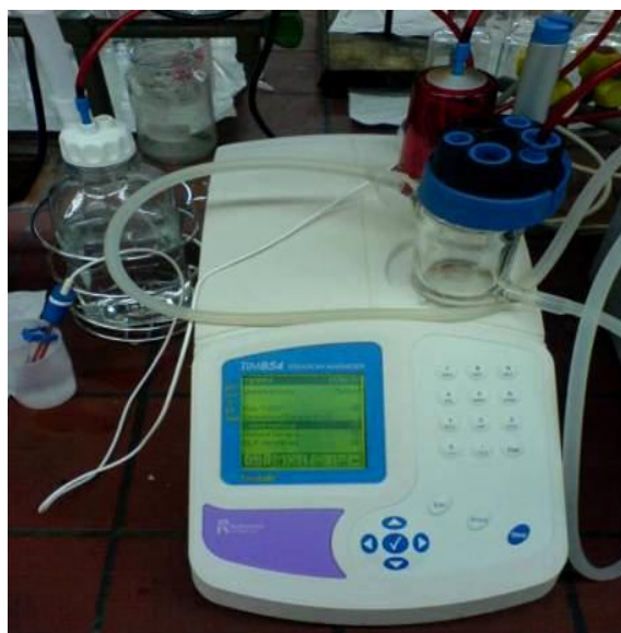
Εικόνα 6.5: ο αυτόματος τιτλοδότης που χρησιμοποιήθηκε για τη μέτρηση της ενεργότητας ΠΜΕ. Διακρίνεται η κυψελίδα μέτρησης η οποία διατηρείται σε σταθερή θερμοκρασία 30°C μέσω κυκλοφορίας θερμού νερού καθώς και η φιάλη με το διάλυμα NaOH (δεξιά)
