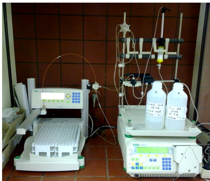
Εικόνα 6.1: Διάταξη χρωματογραφίας κατιοντοεναλλαγής. Διακρίνονται οι φιάλες των ρυθμιστικών διαλυμάτων (κέντρο δεξιά) (με άλας και χωρίς), η στήλη κατιοντοεναλλαγής (πάνω δεξιά) και ο αυτόματος συλλέκτης κλασμάτων (αριστερά). Η ίδια διάταξη χρησιμοποιήθηκε και για τη χρωματογραφία μοριακής διήθησης, με αλλαγή της στήλης.
