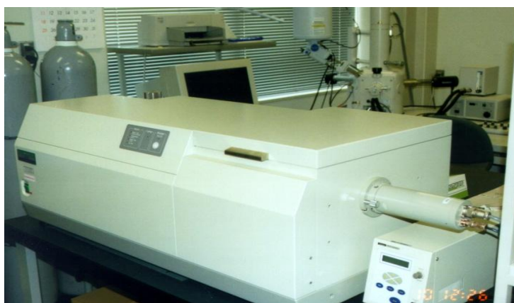
Εικόνα 5.1: Φασματοπολαρόμετρο που χρησιμοποιήθηκε στη μελέτη της δομής ΠΜΕ από πορτοκάλι Valencia μετά από επεξεργασία με ΥΥΠ (Πηγή:[78])
