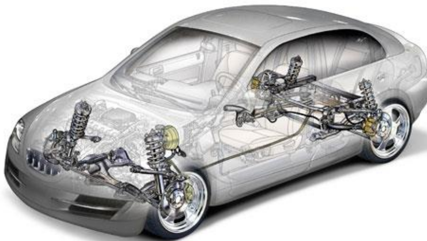
Σχήμα 1.1 Σχηματική απεικόνιση οχήματος με έμφαση στο σύστημα ανάρτησης και της συνδεσμολογίας του
