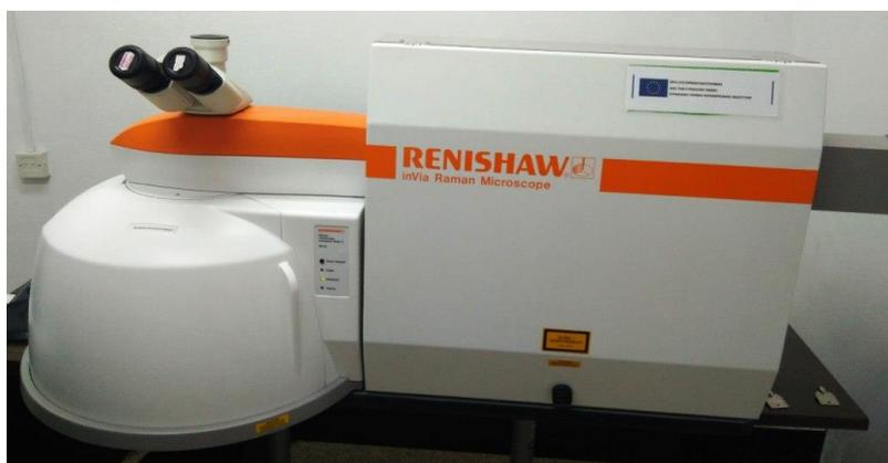
Εικόνα 3.4: Φασματοσκόπιο Raman InVia Raman Microscope
