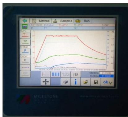
Εικόνα 4.5.2: Οθόνη ελέγχου αντιδραστήρα μικροκυμάτων.
