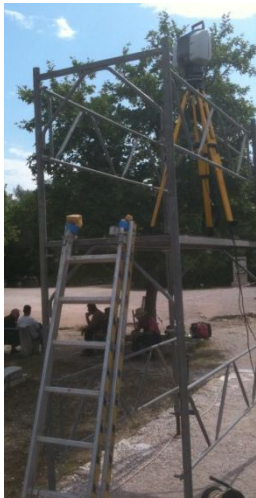
Εικόνα 3.2 : Ο τρισδιάστατος σαρωτής τοποθετημένος στη σκαλωσιά.
