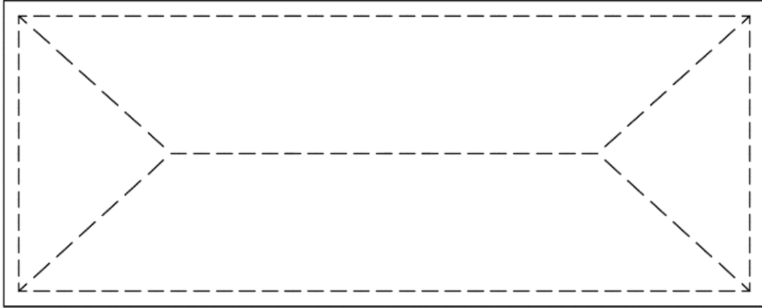
Σχήμα 36. Γραμμές διαρροής σε πακτωμένο ορθογώνιο έλασμα (Καρύδης, 2000)
