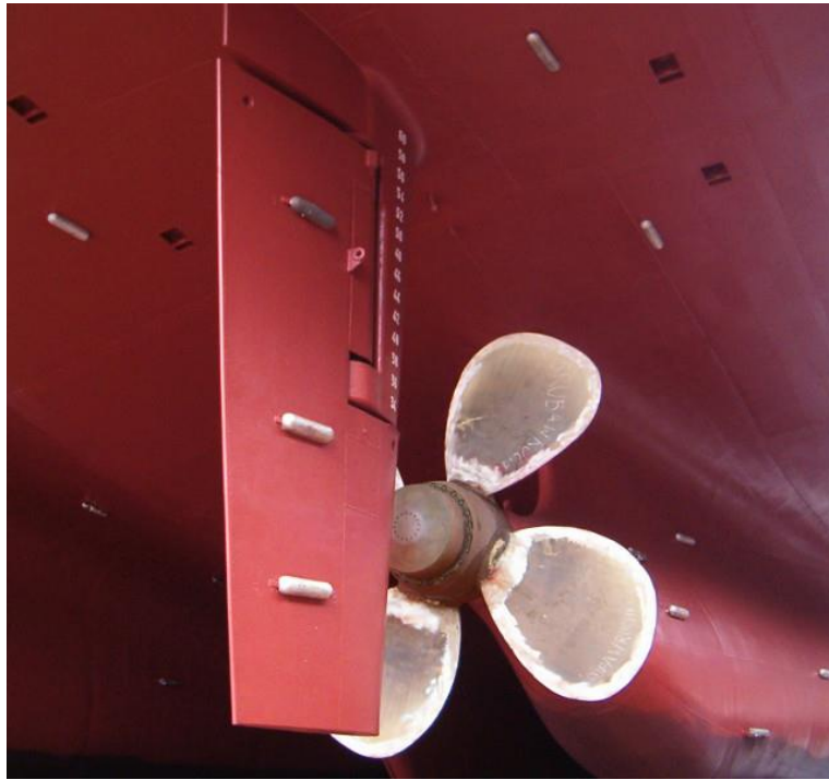
Εικόνα 1.6: Τοποθέτηση Θυσιαζόμενων Ανόδων στην γάστρα πλοίων (4)
