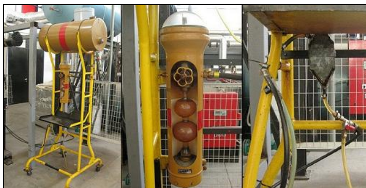
Εικόνα 2.19 Το σύστημα τροφοδοσίας και προσαγωγής του καυσίμου στον κινητήρα: δεξαμενή πετρελαίου (αριστερά), ογκομετρικά δοχεία (κέντρο), δοχείο κατευνασμού (δεξιά).
