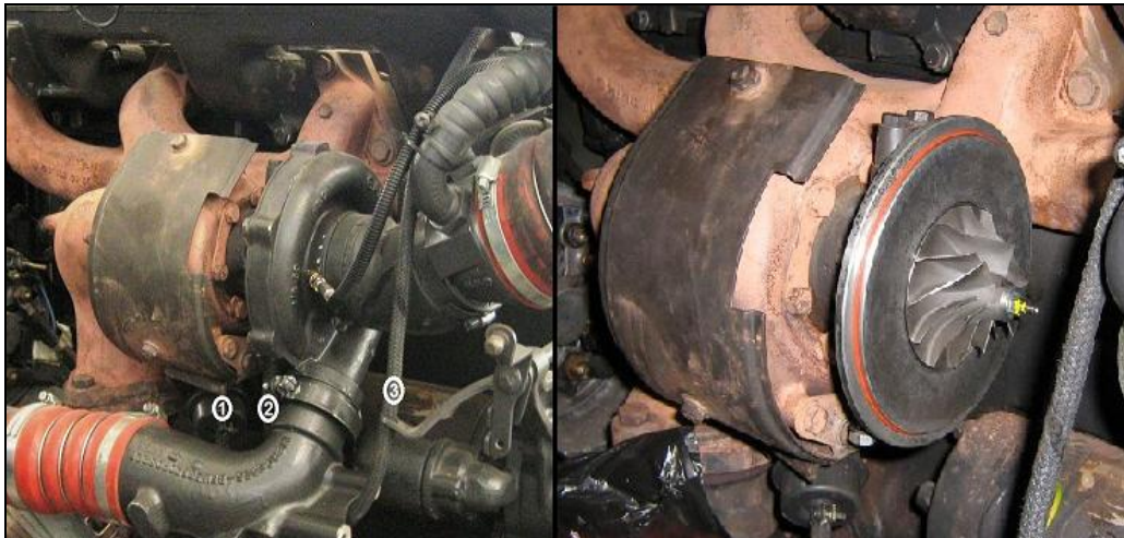
Εικόνα 2.16 Φωτογραφική άποψη του υπερπληρωτή. Αριστερά: (1) η βαλβίδα παράκαμψης του στρόβιλου, (2) η παροχή λαδιού στον άξονα του ζεύγους και (3) η σωλήνωση πίεσης της πολλαπλής εισαγωγής προς τη βαλβίδα παράκαμψης. Δεξιά: Η πτερωτή του συμπιεστή.
