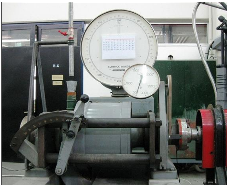
Εικόνα 2.22 Η υδραυλική πέδη Schenck U1-40. Διακρίνονται το δυναμόμετρο, το στροφόμετρο της πέδης και ο μοχλός ρύθμισης του φορτίου της.
