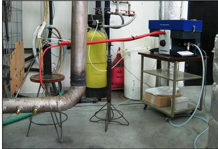
Εικόνα 3.30 Ο αναλυτής AVL 439 όπως εγκαταστάθηκε και χρησιμοποιήθηκε στην πειραματική κλίνη του κινητήρα diesel Mercedes-Benz OM 366 LA.
