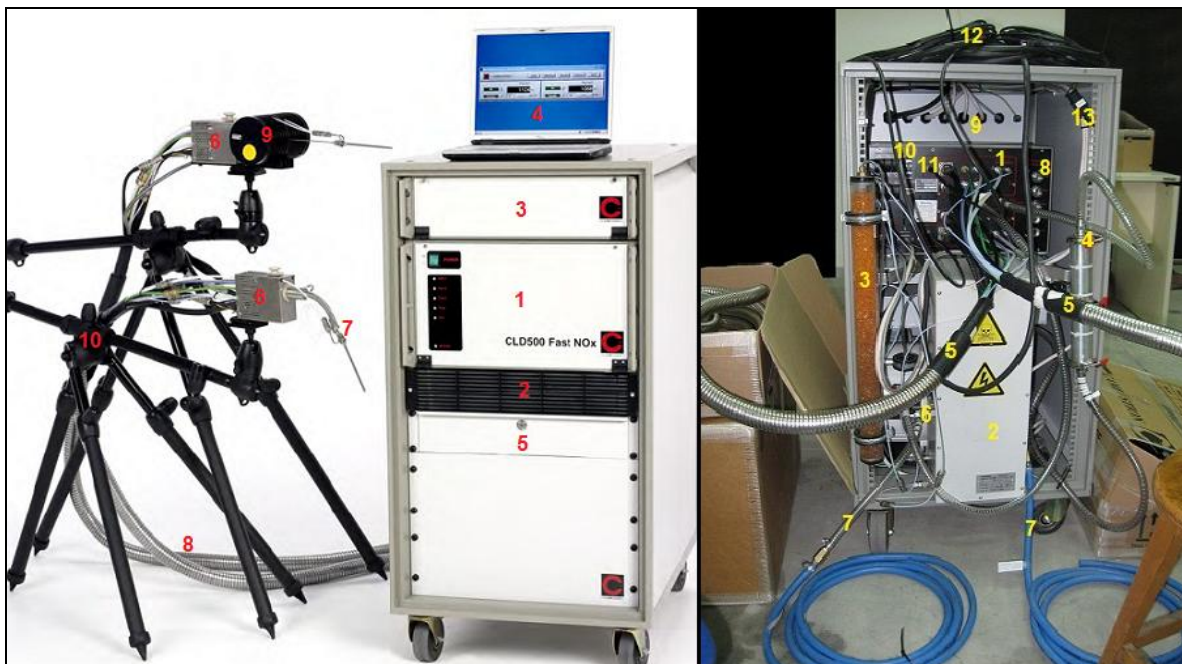
Εικόνα 3.5 Ο αναλυτής CLD 500 και τα δομικά του στοιχεία.
