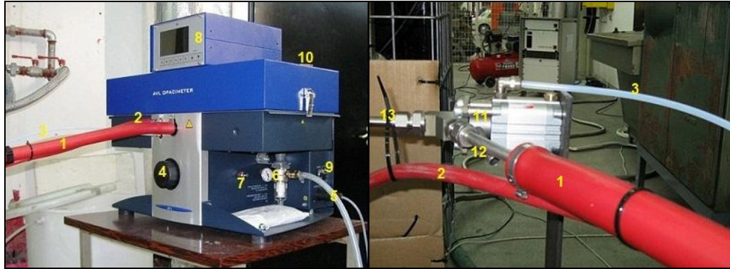
Εικόνα 3.20 Γενική φωτογραφική άποψη του αναλυτή AVL 439 (αριστερά) και λεπτομέρεια της τρίοδης βάνας της γραμμής δειγματοληψίας (δεξιά). Διακρίνονται (1) η γραμμή δειγματοληψίας, (2) η γραμμή επιστροφής, (3) η γραμμή ελέγχου της τρίοδης βάνας, (4) το φίλτρο, (5) η παροχή συμπιεσμένου αέρα, (6) ο αφυγραντήρας με το ρυθμιστή πίεσης, (7) η έξοδος του αέρα μηδενισμού, (8) η συσκευή AVL 4210 για τον έλεγχο του αναλυτή, (9) η τροφοδοσία, (10) το κάλυμμα της εισαγωγής των φίλτρων βαθμονόμησης, (11) η τρίοδη βάνα της γραμμής δειγματοληψίας, (12) η είσοδος του αέρα μηδενισμού και (13) η σωλήνωση δειγματοληψίας από την εξάτμιση του κινητήρα.
