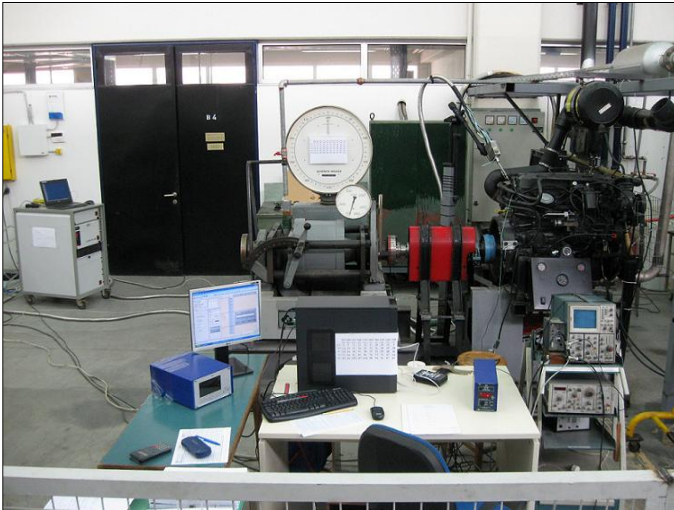
Εικόνα 2.21α Γενική φωτογραφική άποψη της πειραματικής εγκατάστασης του κινητήρα diesel Mercedes-Benz OM 366 LA.
