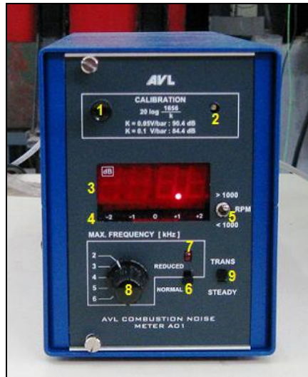
Εικόνα 3.34 Ο αναλυτής θορύβου της καύσης AVL 450, όπου διακρίνονται (1) ο διακόπτης και (2) το ποτενσιόμετρο βαθμονόμησης, (3) η ένδειξη της μετρούμενης τιμής, (4) η διακύμανση της ένδειξης, (5) ο διακόπτης επιλογής του εύρους της ταχύτητας περιστροφής του κινητήρα, (6) ο διακόπτης ενεργοποίησης χαμηλοπερατού φίλτρου, (7) η ένδειξη ενεργοποίησης χαμηλοπερατού φίλτρου (φωτοδίοδος LED), (8) ο διακόπτης επιλογής συγκεκριμένου χαμηλοπερατού φίλτρου και (9) η επιλογή της κατάστασης λειτουργίας και της χρονικής σταθεράς του αναλυτή.
