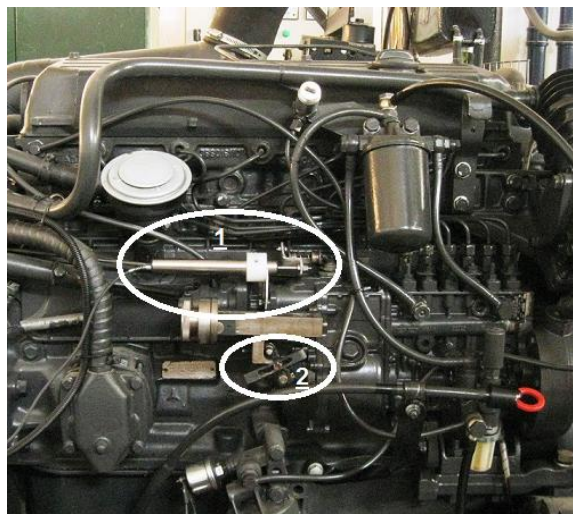
Εικόνα 2.26 Εγκατάσταση του μετατροπέα LVDT Solartron Metrology DC25 (1) στην αντλία πετρελαίου και του ρυθμιζόμενου τερματικού (2) στο πετάλι του γκαζιού.
