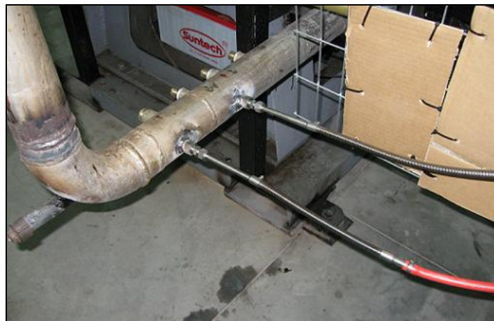
Εικόνα 3.31 Λεπτομέρεια από την τοποθέτηση των γραμμών δειγματοληψίας και επιστροφής του αναλυτή AVL 439 στην εξάτμιση του κινητήρα.
