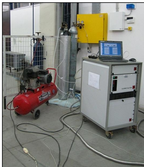
Εικόνα 3.18 Ο αναλυτής CLD 500 όπως εγκαταστάθηκε και χρησιμοποιήθηκε στην πειραματική κλίνη του κινητήρα diesel Mercedes-Benz OM 366 LA.
