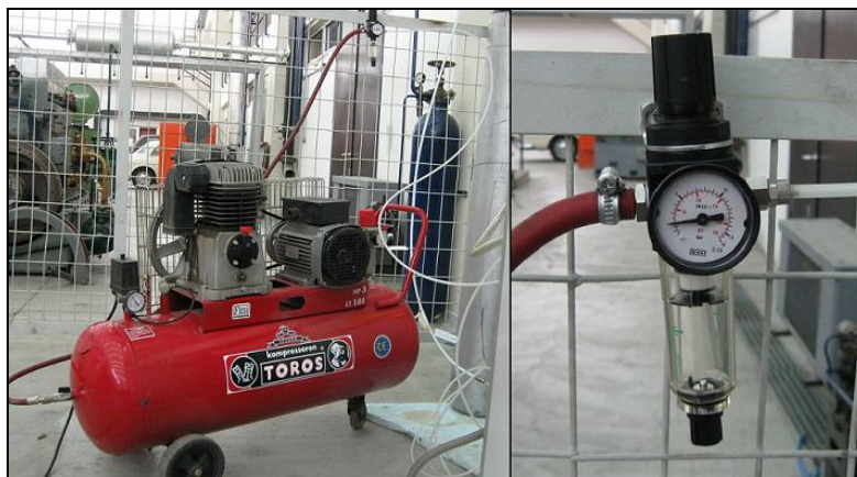
Εικόνα 3.14 Ο αεροσυμπιεστής και ο αφυγραντήρας με το ρυθμιστή πίεσης για την παροχή του αέρα καθαρισμού στον αναλυτή CLD 500.
