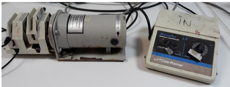
Εικόνα 3.3 Περισταλτική αντλία διπλή ρυθμιζόμενης έντασης
