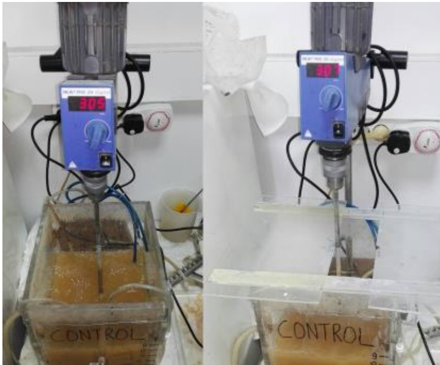
Εικόνα 3.1 Αντιδραστήρας εναλλασσόμενων φάσεων SBR
