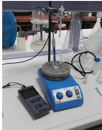
Εικόνα 3.11 Μέτρηση αλκαλικότητας με χρήση μαγνητικού αναδευτήρα και pH-μέτρου
