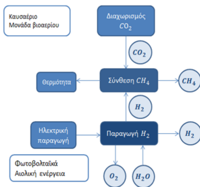
Εικόνα 31: Διάγραμμα ροής της παραγωγής H_2 και CH_4 με PtG [3]
