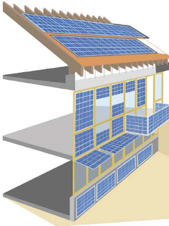
Εικόνα 2.2. Τρόποι εγκατάστασης Φ/Β συστήματος σε κτίριο [1]
