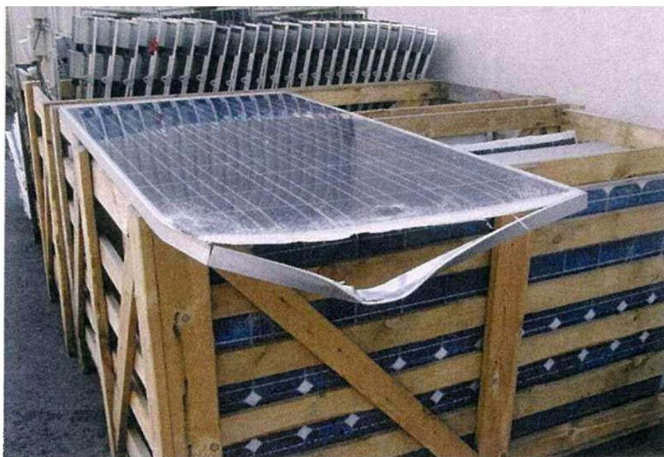
Εικόνα 1.2 Ελαττωματικά πλαίσια προς ανακύκλωση [5]
