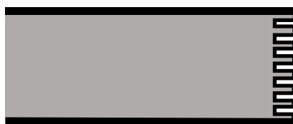
Εικόνα 20 – Αναδιπλώσεις περιβλήματος σε ελικοειδές σχήμα (σερπαντίνα).
