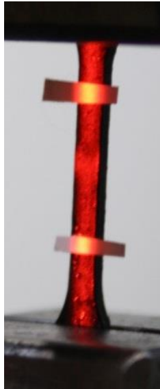
Εικόνα 2.7. Η δέσμη laser του οπτικού μηκυσιόμετρου και οι λευκές ταινίες που οριοθετούν την περιοχή μέτρησης της ανηγμένης παραμόρφωσης (Gauge Length).
