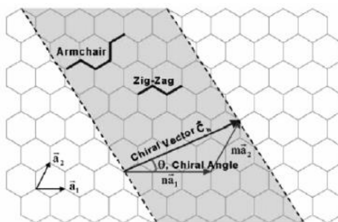
Εικόνα 1.11. Εξαγωνική δομή γραφενίου που όταν τυλιχτεί σχηματίζει έναν νανοσωλήνα άνθρακα (Moniruzzaman 2006).
