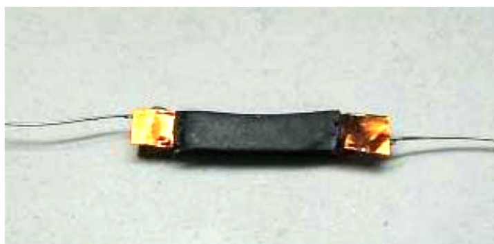
Εικόνα 1.25. Φωτογραφία επικολλούμενου αισθητήρα μορφής ψηφίδας (Yasuoka 2013).
