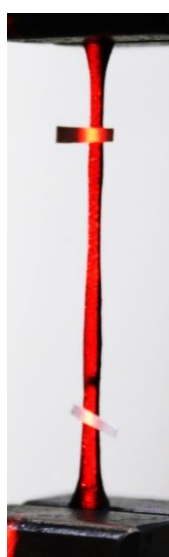
Εικόνα 3.16. Δοκίμιο mLLDPE με CNTs που έχουν δημιουργηθεί πολλοί λαιμοί.
