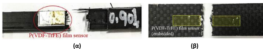
Εικόνα 1.26. Θραύση δοκιμίου με αισθητήρα μορφής υμενίου (α) επικολλημένο στην επιφάνειά του και (β) ενσωματωμένο στο εσωτερικό του (Bae 2018).
