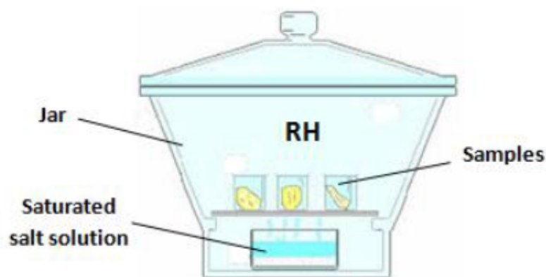
ΣΧΗΜΑ 6.4: Γυάλα αποθήκευσης των υδρογελών για την επίτευξη χαρακτηριστικής σχετικής υγρασίας.[5]
