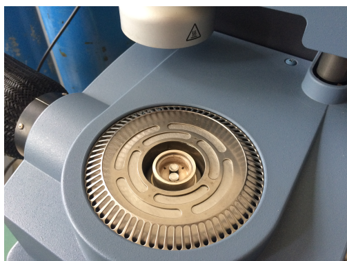
ΣΧΗΜΑ 6.1: Η κυψελίδα του θερμιδόμετρου. Επικοινωνεί με το σύστημα ψύξης μέσω του μαύρου παχύ σωλήνα.
