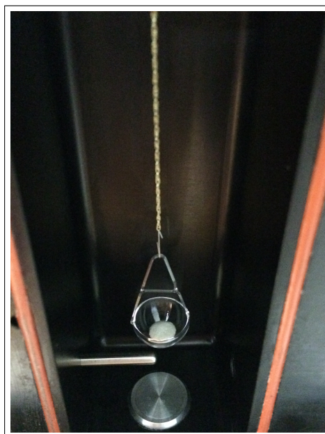
ΣΧΗΜΑ 5.1: Δείγμα Γαλουρονικού Οξέος μες στο ζυγό της πειραματικής διάταξης.
