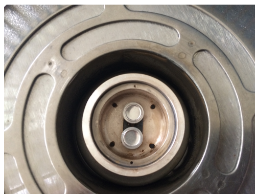
ΣΧΗΜΑ 6.2: Τοποθέτηση δειγμάτων στην κυψελίδα. Πάνω το δείγμα αναφοράς και κάτω το δείγμα με το υλικό.
