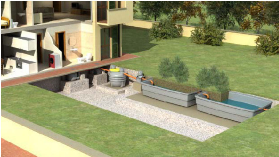
Εικόνα 3.51 : Διάταξη λεκανών φυτοκαθαρισμού σε κατοικία (Πηγή : www.biotecs.gr )
