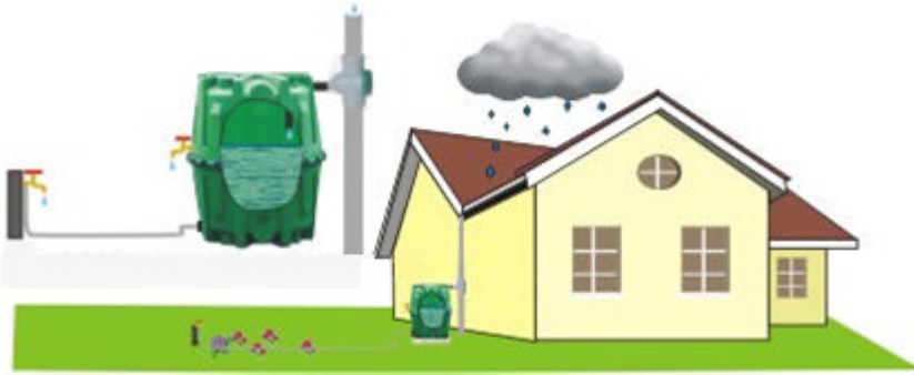
Εικόνα 3.2 : Υπέργεια δεξαμενή συλλογής βρόχινου νερού (Πηγή : http://www.rainwaterharvesting.co.uk )
