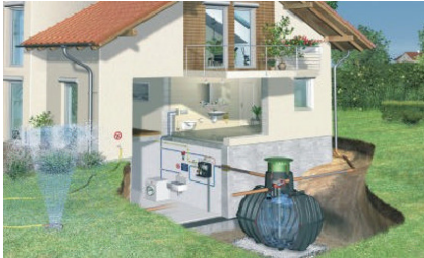
Εικόνα 3.7 : Ολοκληρωμένο σύστημα αξιοποίησης βρόχινου νερού (Πηγή : http://www.rainwaterharvesting.co.uk )
