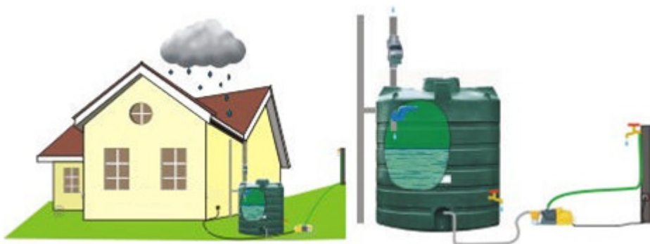
Εικόνα 3.3 : Υπέργεια δεξαμενή συλλογής βρόχινου νερού με αντλία (Πηγή : http://www.rainwaterharvesting.co.uk )
