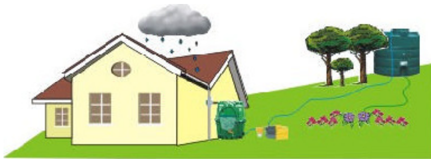
Εικόνα 3.5 : Υπέργεια δεξαμενή αποθήκευσης με μικρό δοχείο συλλογής (2) (Πηγή : http://www.rainwaterharvesting.co.uk )
