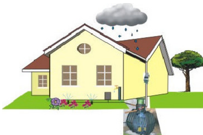
Εικόνα 3.6 : Υπόγειο σύστημα συλλογής (Πηγή : http://www.rainwaterharvesting.co.uk )
