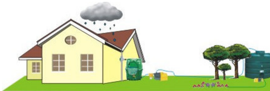
Εικόνα 3.4 : Υπέργεια δεξαμενή αποθήκευσης με μικρό δοχείο συλλογής (1) (Πηγή : http://www.rainwaterharvesting.co.uk )
