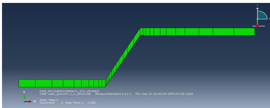
Εικόνα 4.33 : Προσομοίωση του αγωγού για γωνία κλίσης πρανούς 60° στο Abaqus Cae.
