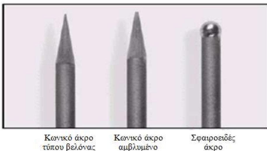
Εικόνα 2.9: Μορφές γεωμετρίας ηλεκτροδίων βολφραμίου
