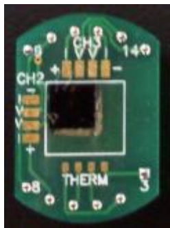
Εικόνα 35: Δειματοφορέας (puck) PPMS [44]
