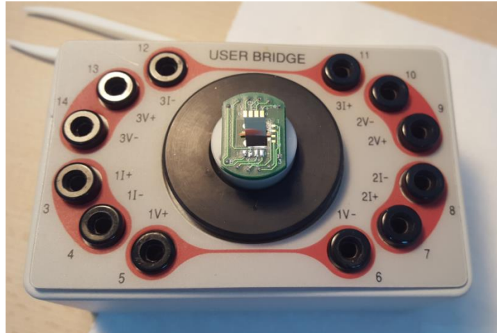
Εικόνα 74: Τοποθέτηση του δείγματος στο ειδικό δοκιμαστικό κουτί ελέγχου της σύνδεσης των επαφών
