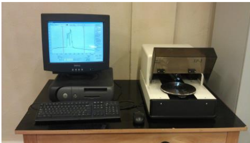
Εικόνα 46: Προφιλόμετρο Ambios Technology XP-2 [53]
