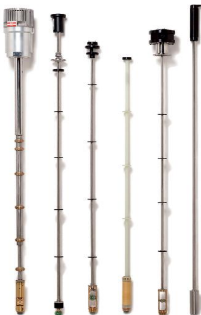
Εικόνα 36: Ράβδοι-καθετήρες εισαγωγής του δείγματος στο ψυχόμενο δοχείο του PPMS [42]
