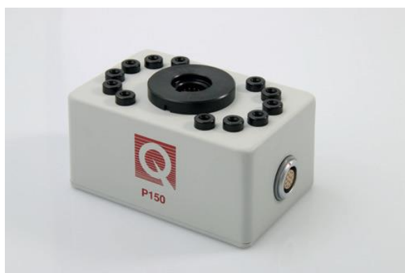
Εικόνα 34: Δοκιμαστικό κουτί ελέγχου της σύνδεσης των επαφών στο δείγμα [43]
