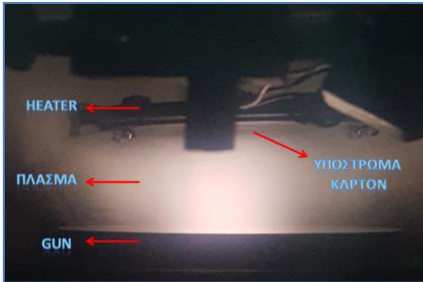
Εικόνα 44: Εναπόθεση βισμούθιου με τη διαδικασία του sputtering
