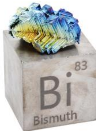
Εικόνα 3: Αποχρώσεις Βισμούθιου λόγω οξείδωσής του [4]
