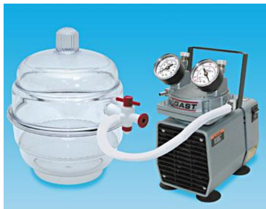
Εικόνα 45: Αποθήκευση δειγμάτων σε ξηραντήρα κενού (vacuum desiccator) [51]
