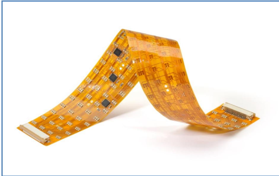
Εικόνα 15: Χρήση φιλμ πολυιμιδίου σε κύκλωμα Η/Υ[17]
