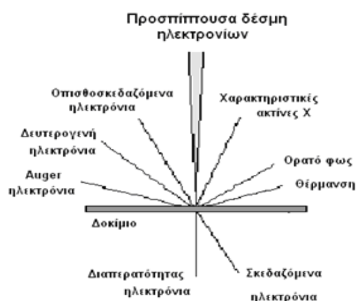
Εικόνα 26: Γωνίες ανακλάσεως των διαφόρων e^- κατά τη λειτουργία ενός SEM
