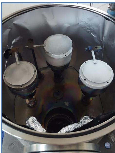
Εικόνα 42: Εσωτερικό θαλάμου κενού μηχανήματος sputtering
