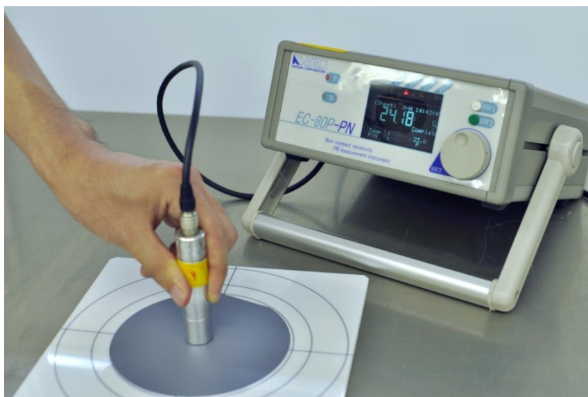
Εικόνα 20: Συσκευή μέτρησης της αντίστασης ενός υμενίου με την τεχνική τεσσάρων σημείων
