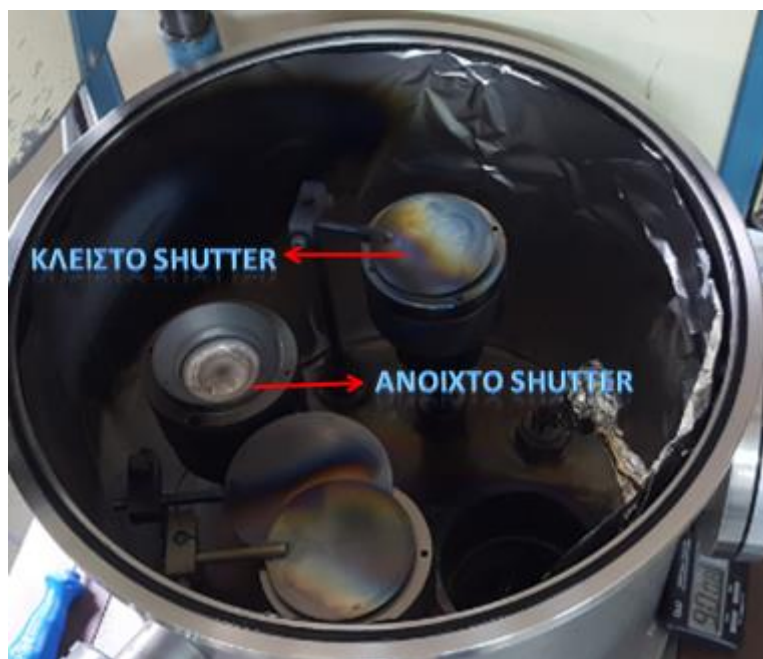
Εικόνα 43: Θέση shutter εντός θαλάμου υψηλού κενού
