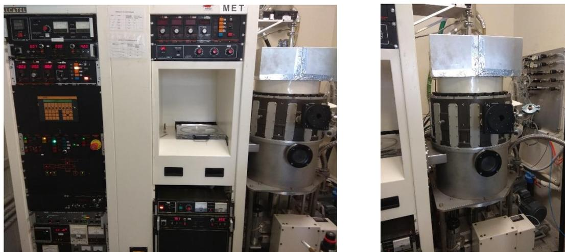
Εικόνα 3.2-2 Φωτογραφίες του αντιδραστήρα πλάσματος που χρησιμοποιήθηκε για την κατασκευή υπερυδροφобων επιφανειών
