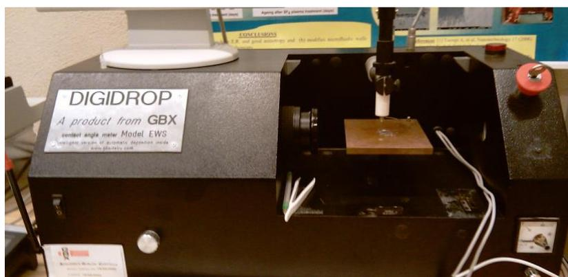
Εικόνα 3.3-1: Όργανο μέτρησης γωνίας επαφής
