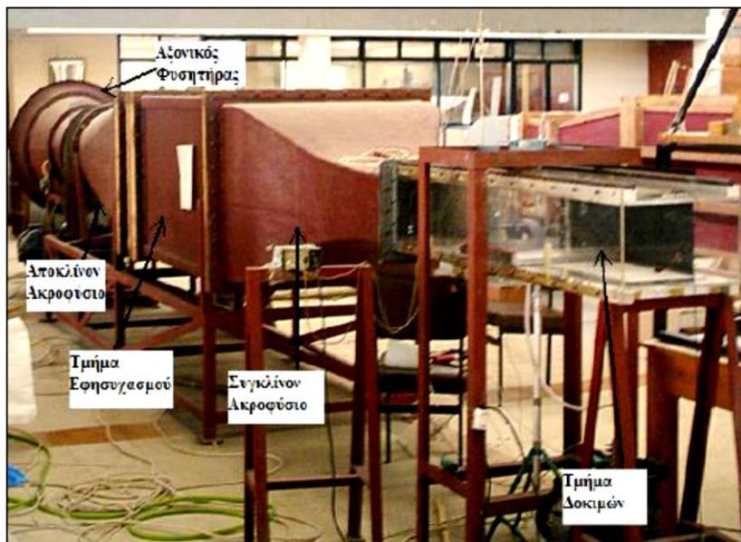
Εικόνα 3.5-1 Φωτογραφία της αεροσήραγγας που χρησιμοποιήθηκε στο πείραμα
