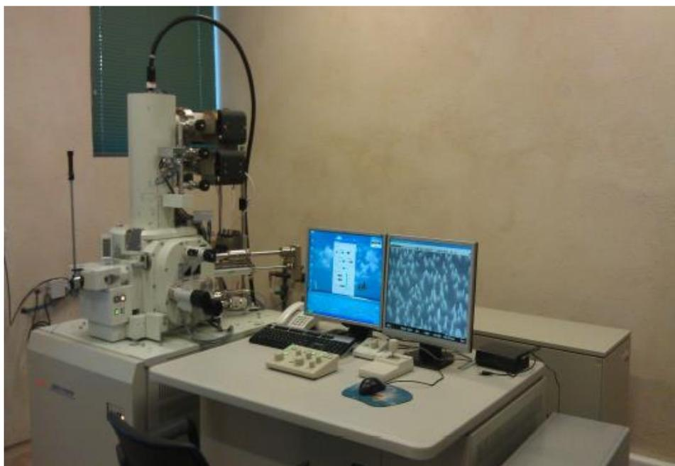
Εικόνα 2.3-7 Μικροσκόπιο σάρωσης ηλεκτρονικής δέσμης (SEM) JEOL JSM-7401F FEG του Ινστιτούτου Νανοτεχνολογίας και Νανοεπιστήμης του ΕΚΕΦΕ “Δημόκριτος”
