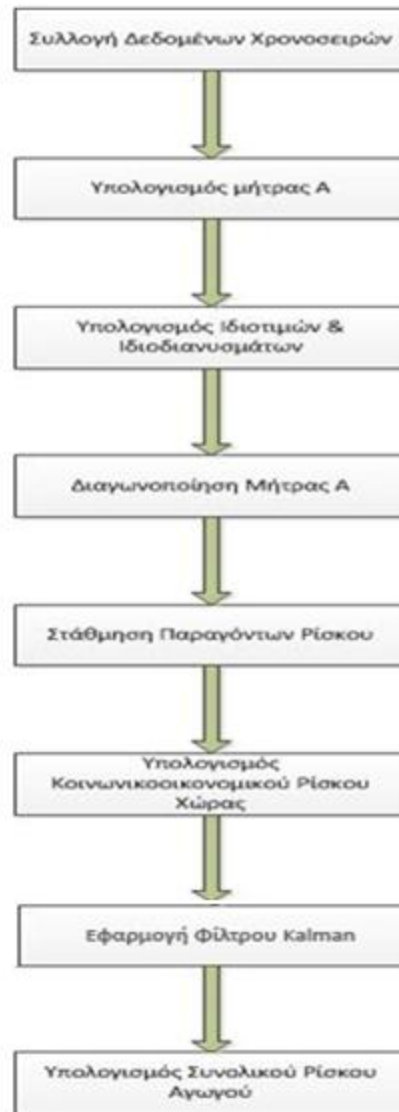
Εικόνα 4.3: Βήματα υπολογισμού συνολικού ρίσκου αγωγού
