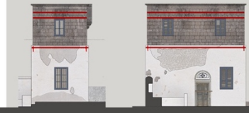
Μεταλλικά αγκύρια σε διαφορετικά επίπεδα στις όψεις
