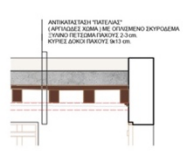
Τομή στέγης - δώματος, κλίμακα 1:20
