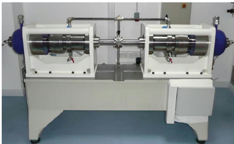
Εικόνα 6.5 Απεικόνιση του Rapid Compression Machine (RCM) στο National University of Galway in Ireland
