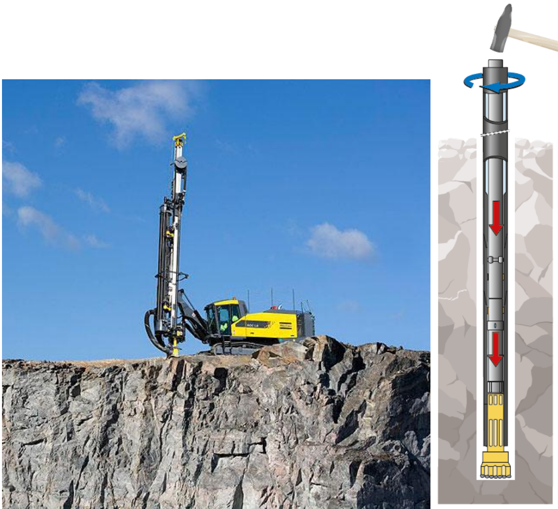
Εικόνα 3.2 - Σύστημα Corprod που συνδυάζει την ταχύτητα της κρουστικής υδραυλικής σφύρας με την ακρίβεια και μεγάλη διάρκεια ζωής της ενδοδιατρηματικής μεθόδου (Atlas Copco Rock Drills - Surface Drilling Equipment for Mines) (αριστερά) και η τομή της σφύρας (πηγή : Atlas Copco)
