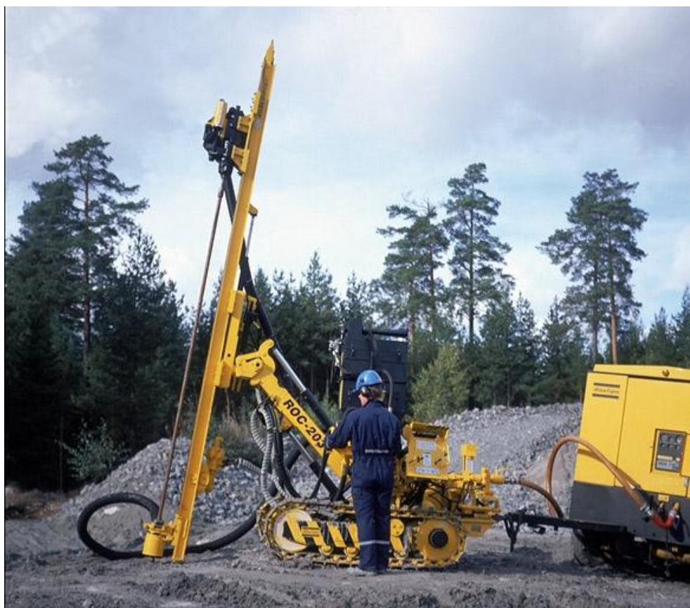
Εικόνα 3.4. – Κρουστική Αερόσφουρα ROC 203 PC-DTH, με δύο κύρια οφέλη: υψηλή ποσοστό διείδυσης και χαμηλή κατανάλωση καυσίμου
