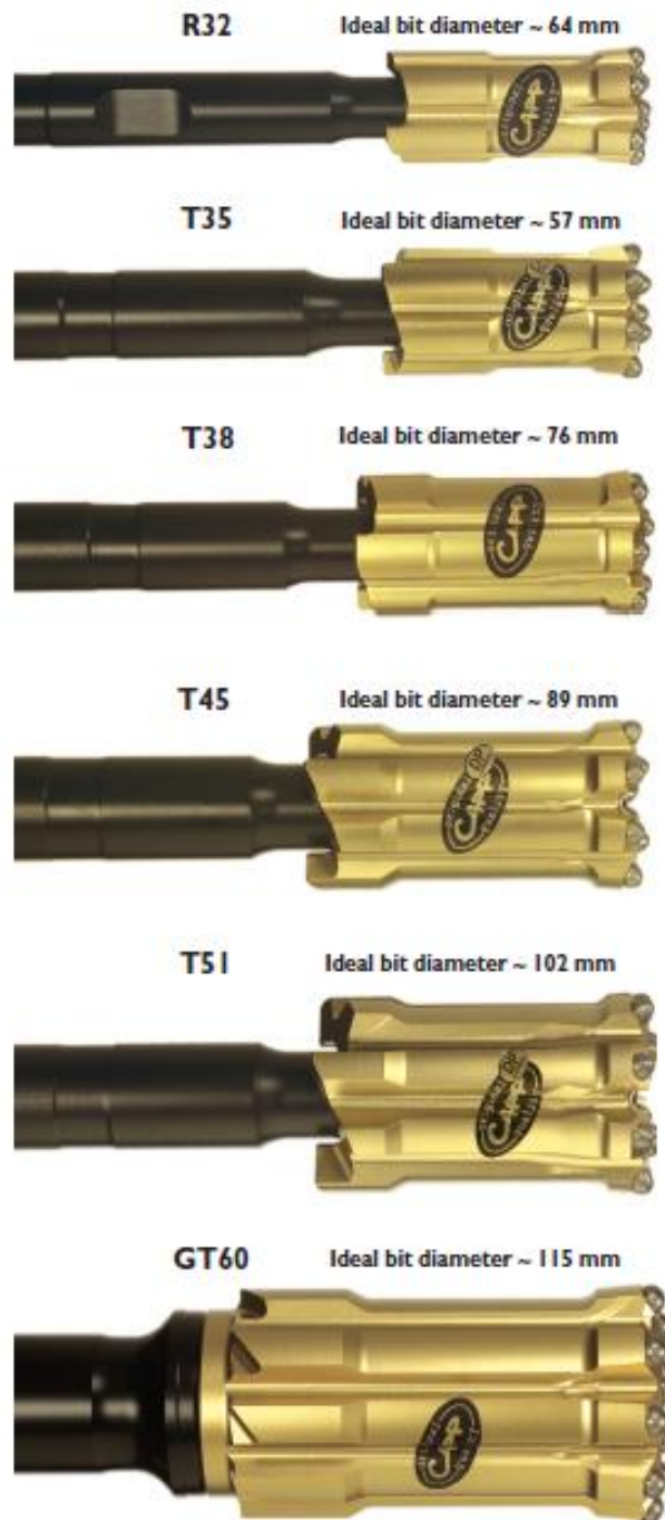
Εικόνα 5.10 – Η ιδανική σχέση μεταξύ διαμέτρων διατρητικού στελέχους και διαμέτρου του κοπτικού άκρου
