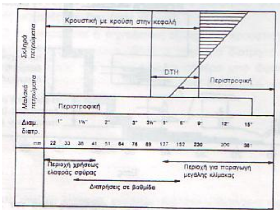
Εικόνα 3.8 - Το πεδίο εφαρμογής των κρουστικών και περιστροφικών μηχανών ορύξεως διατρημάτων (Tamrock)
