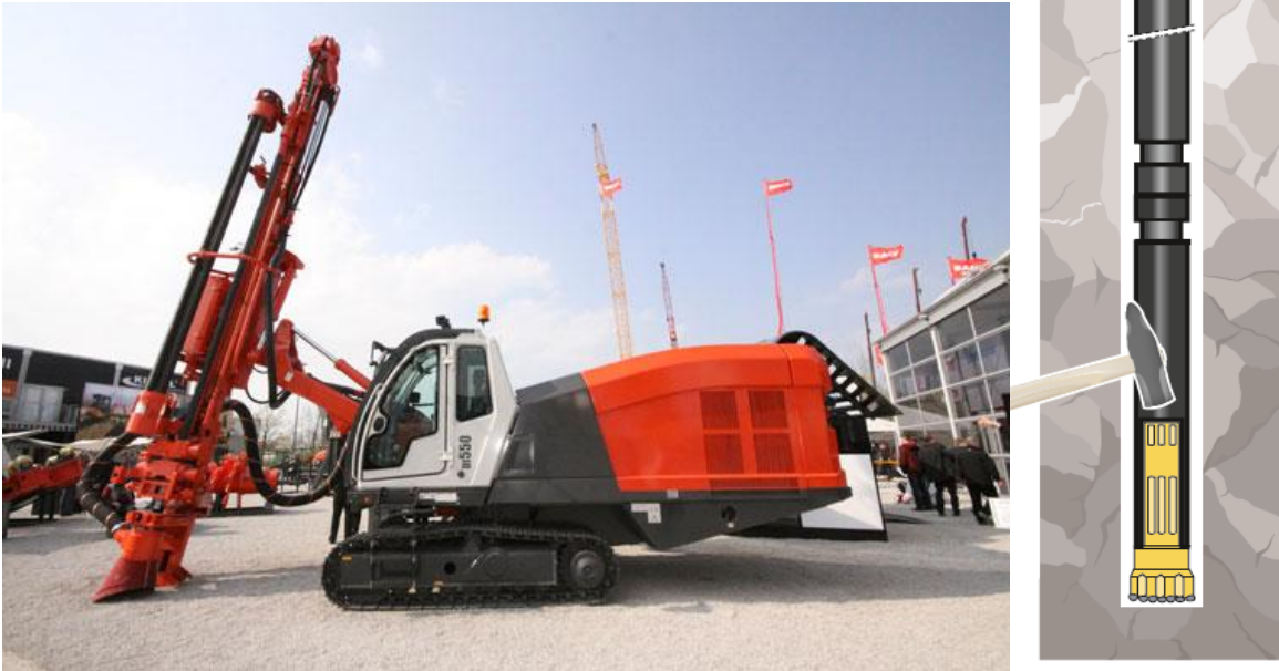
Εικόνα 3.1 - Ενδοδιατρηματική Σφύρα DI550 down the hole drill rig Sandvik (αριστερά) και η τομή της σφύρας (πηγή : Atlas Copco)
