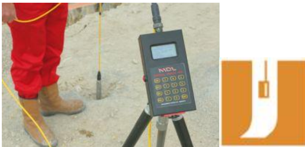
Εικόνα 6.2 – Τρόπος εισαγωγής του αισθητήρα στο διάτρημα για μέτρηση της απόκλισης
