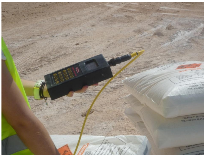
Εικόνα 7.12 – Υπολογισμός της απόκλισης του διατρήματος με τη χρήση του μηχανήματος Cabled Boretrak
