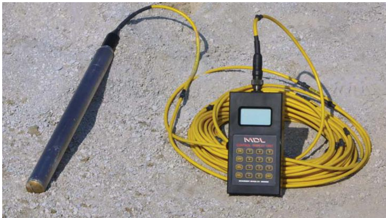
Εικόνα 6.1. - Cabled Boretrak (CB) – Σύστημα μέτρησης της απόκλισης των διατρημάτων της MDL
