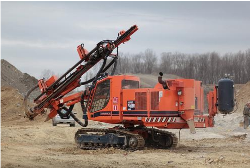
Εικόνα 3.3 -Sandvik DX800 (Tamrock Ranger 800) Top Hammer Drill – Κρουστική Υδραυλική Σφύρα (αριστερά )και η τομή της σφύρας (πηγή : Atlas Copco)
