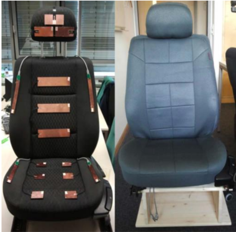
Σχήμα 2.2 Βασική δομή του αισθητήρα χωρητικότητας.
