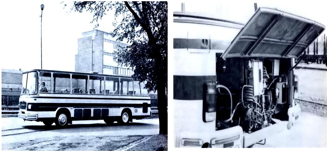
Εικόνα 1.3 : Μηχανή Stirling σε λεωφορείο στα μέσα της δεκαετίας του '60. (Παρατηρείστε τα ψυγεία που βρίσκονται στον αντίστοιχο χώρο των αποσκευών)
