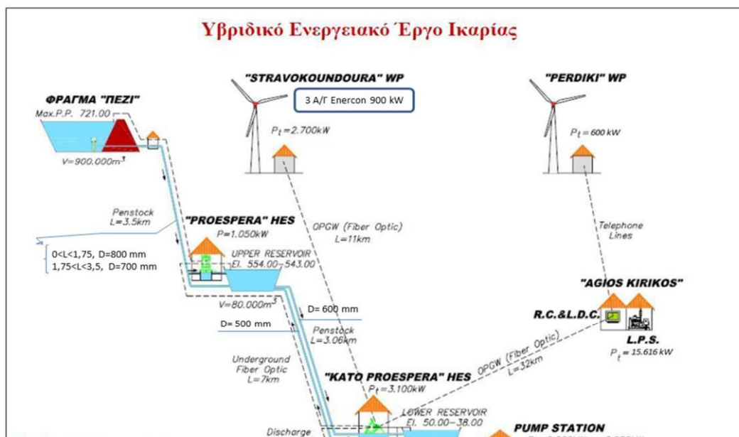
Σχήμα 2.12-Εσωτερική διαμόρφωση του ΥΒΕ και λυτές μονάδες παραγωγής συστήματος της Ικαρίας 2013 (Πηγή: ΔΕΗ Αναανεώσιμες)
