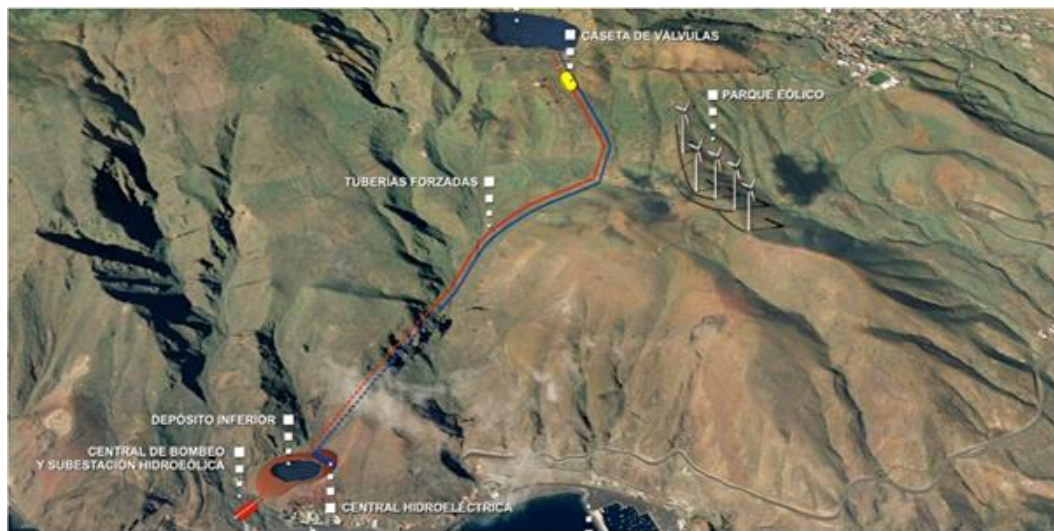
Σχήμα 2.11- Αναπαράσταση του υβριδικού υδροηλεκτρικού συστήματος στο νησί El Hierro
